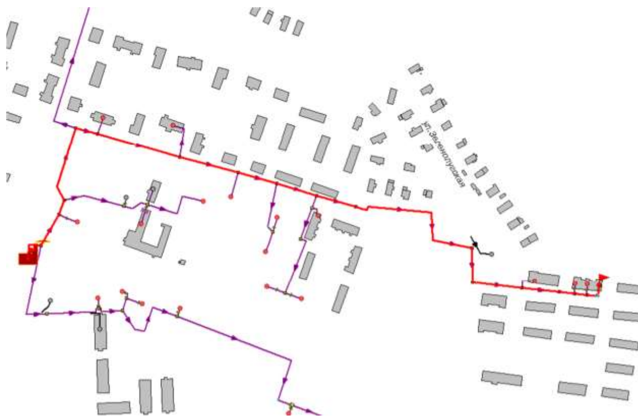
Рисунок 1.13 -Расчетный путь теплоносителя котельной до КЛДК 23, УУ1
