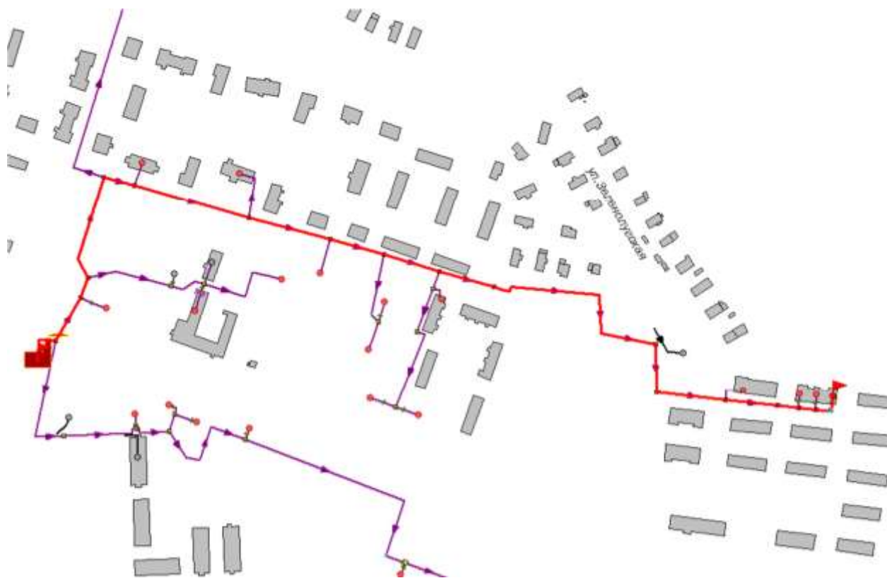
Рисунок 2.13 -Расчетный путь теплоносителя котельной до КЛДК 23, УУ1
