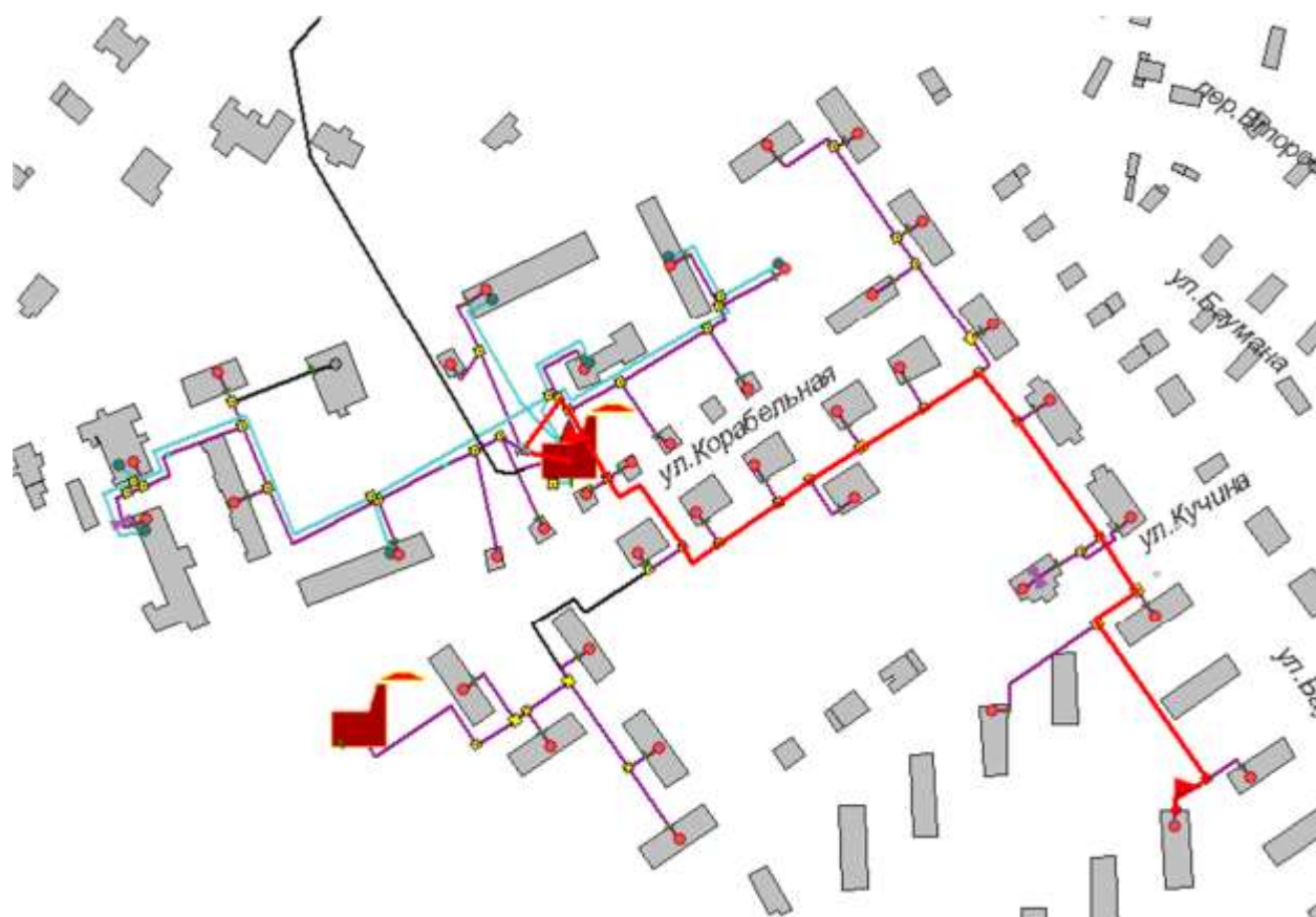
Рисунок 3.75 -Расчетный путь теплоносителя котельной до Баумана,12 к.4
