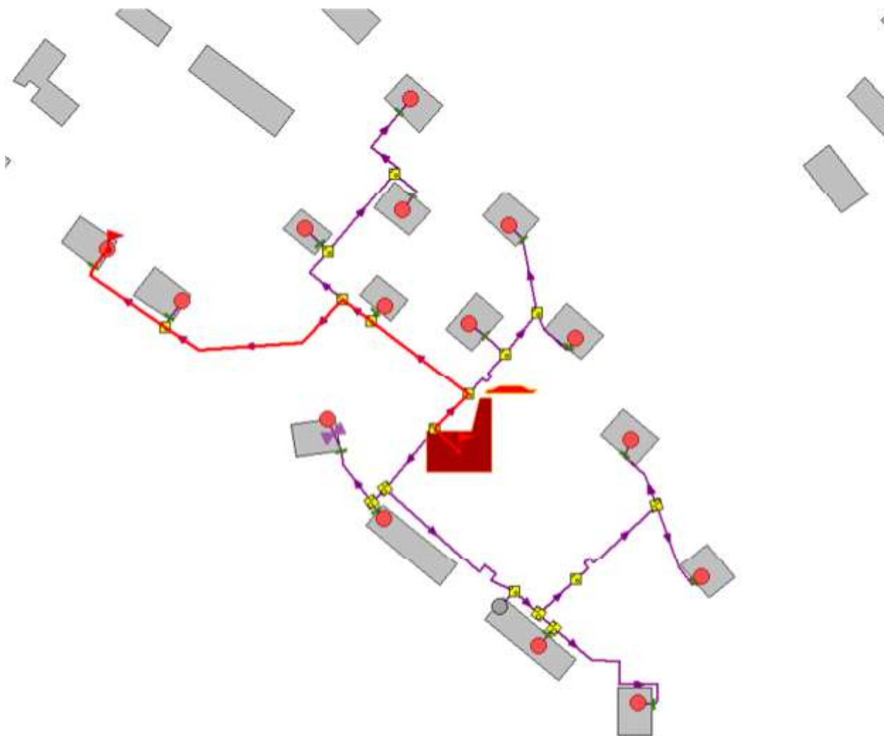
Рисунок 2.19 -Расчетный путь теплоносителя котельной до Дрейера, 15 к.3
