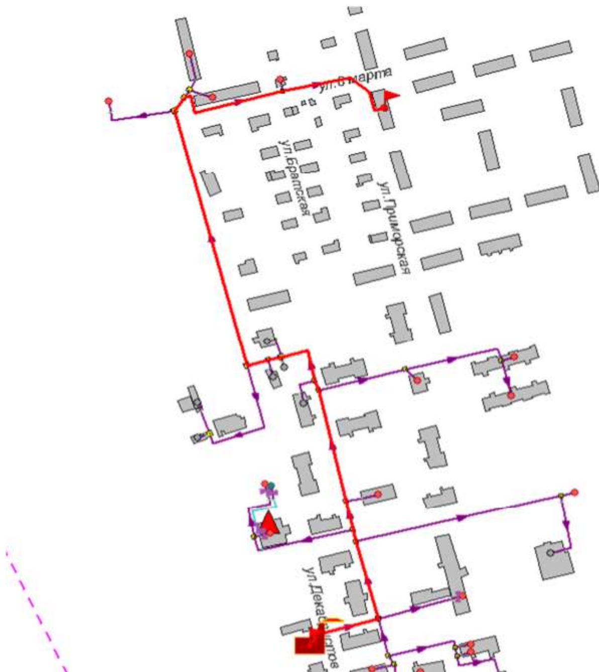
Рисунок 1.63 -Расчетный путь теплоносителя от котельной до Приморская,16
