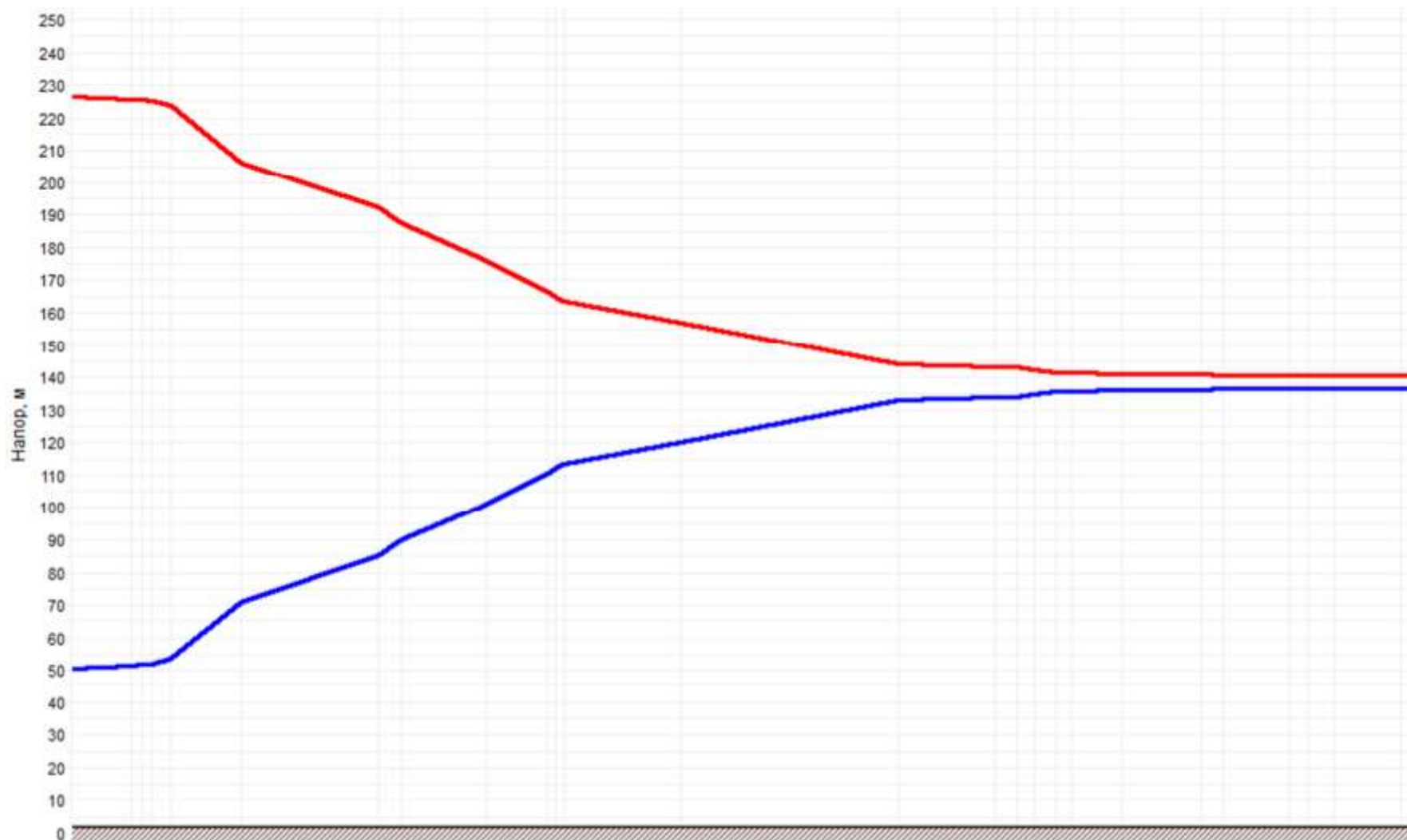
Рисунок 1.90 –График гидравлических режимов рассматриваемого теплопровода
