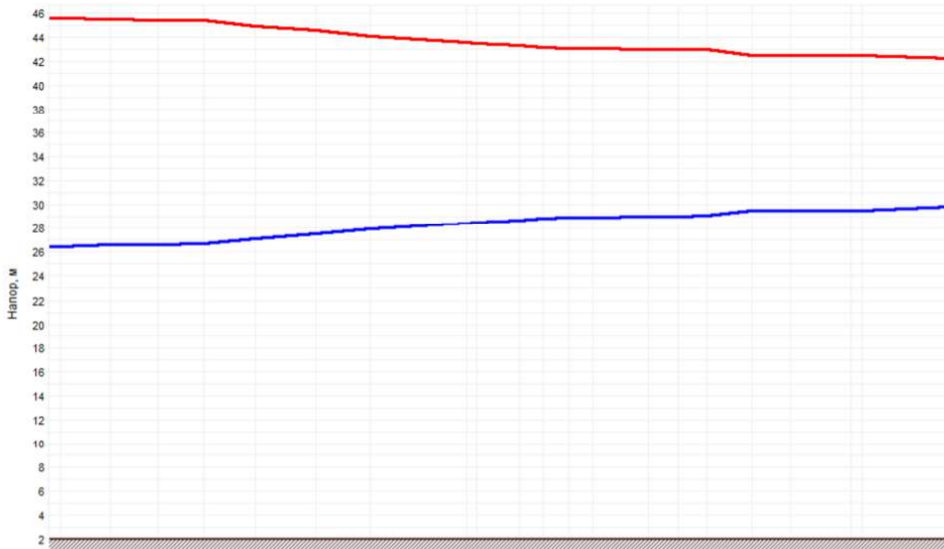
Рисунок 3.16 –График гидравлических режимов рассматриваемого теплопровода
