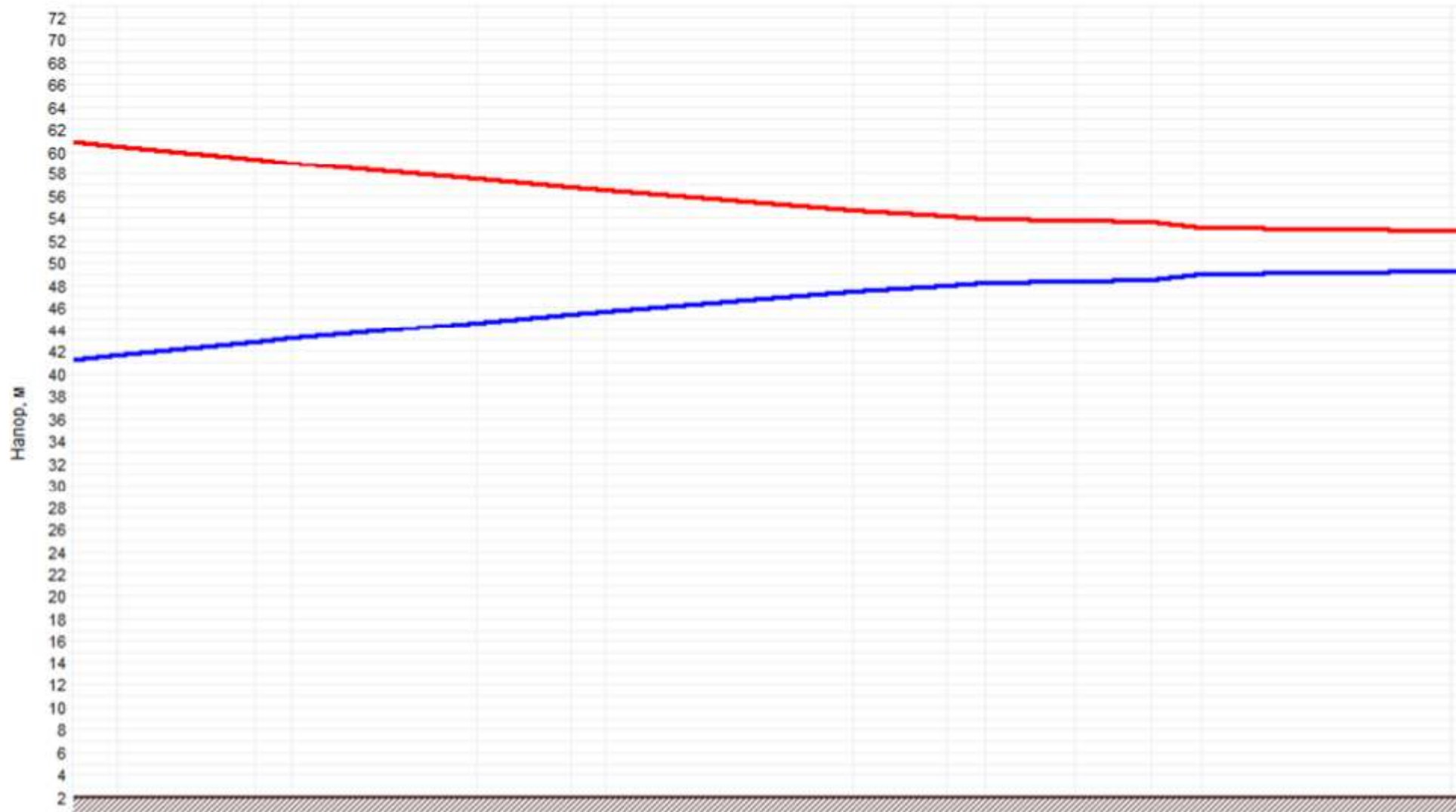
Рисунок 1.34 –График гидравлических режимов рассматриваемого теплопровода
