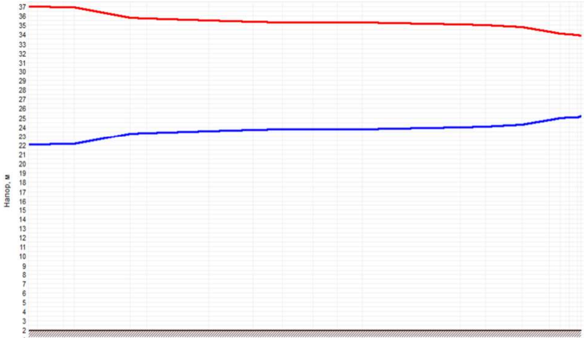
Рисунок 1.14 –График гидравлических режимов рассматриваемого теплопровода
