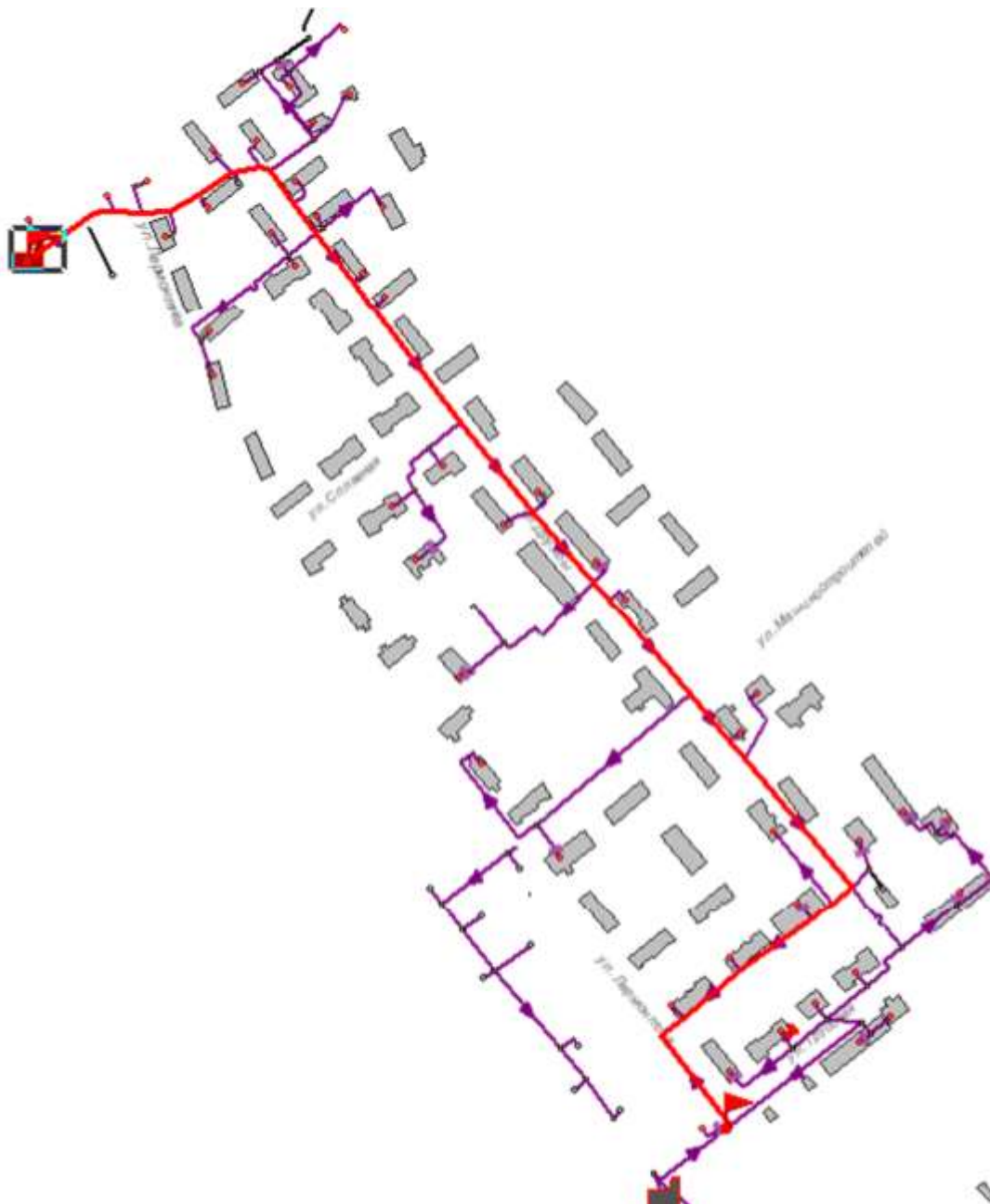
Рисунок 1.33 -Расчетный путь теплоносителя котельной до Лермонтова 23, стр.20
