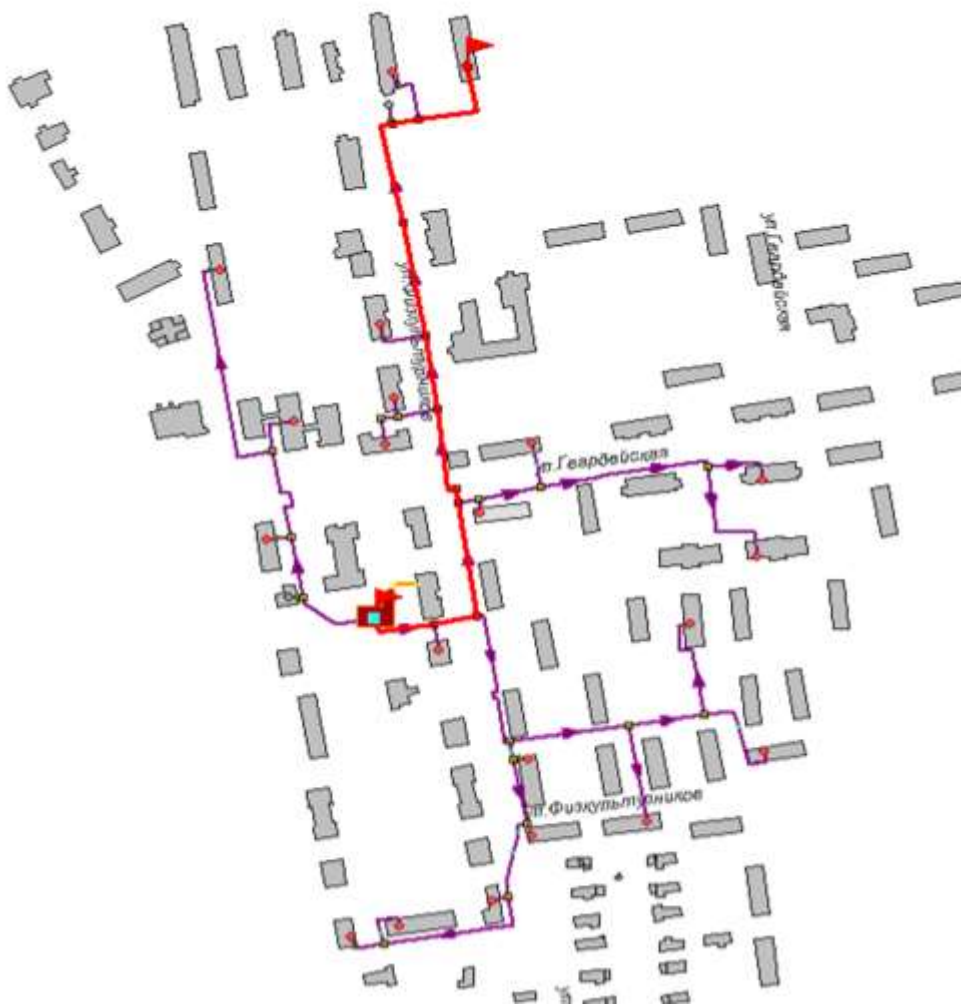
Рисунок 2.71 -Расчетный путь теплоносителя от котельной до Петрова,9
