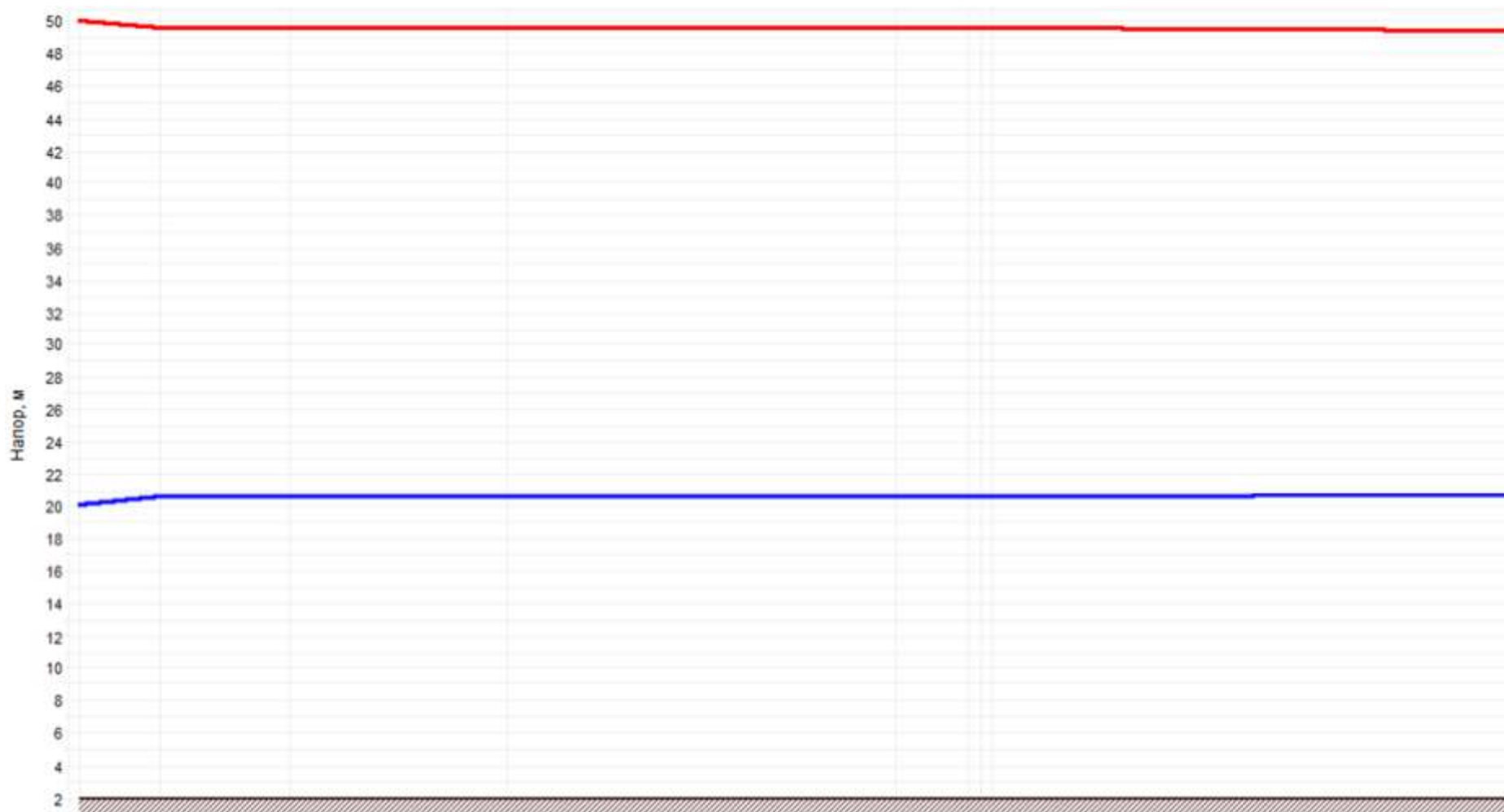
Рисунок 3.94 –График гидравлических режимов рассматриваемого теплопровода
