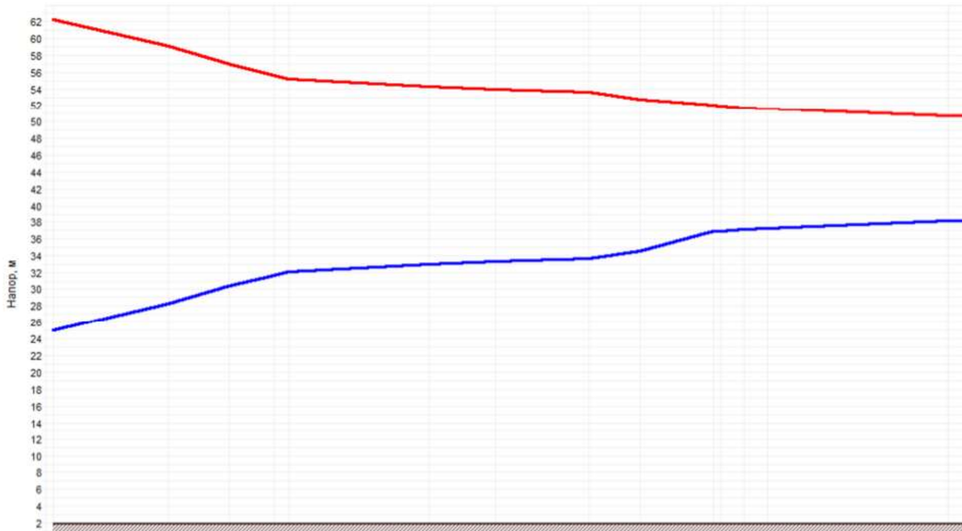
Рисунок 3.40 –График гидравлических режимов рассматриваемого теплопровода
