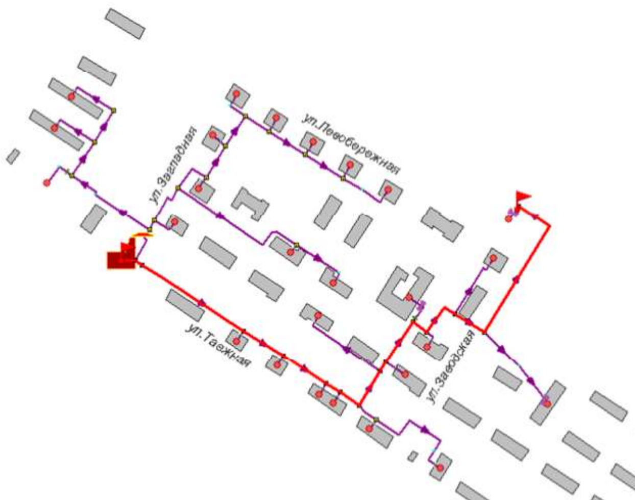
Рисунок 3.57 -Расчетный путь теплоносителя котельной до Турдево,ПЧ-70
