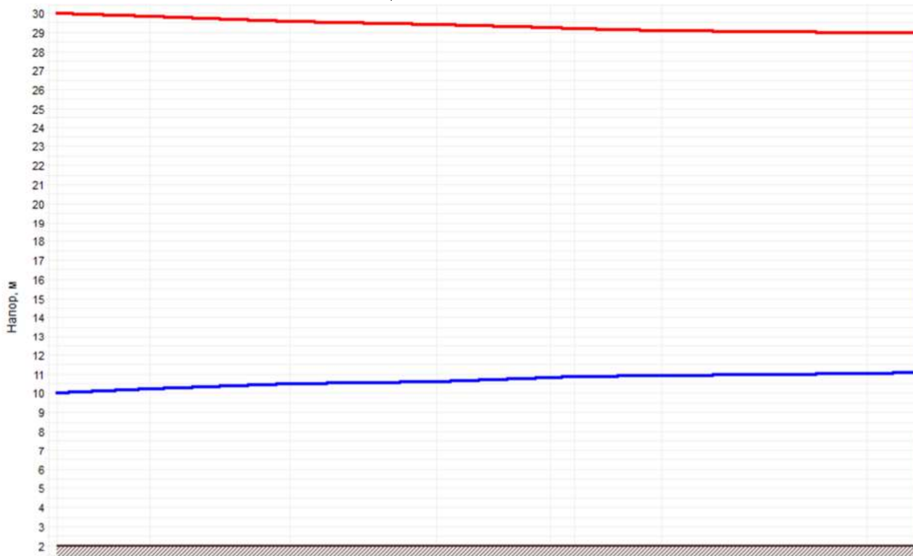
Рисунок 2.44 –График гидравлических режимов рассматриваемого теплопровода
