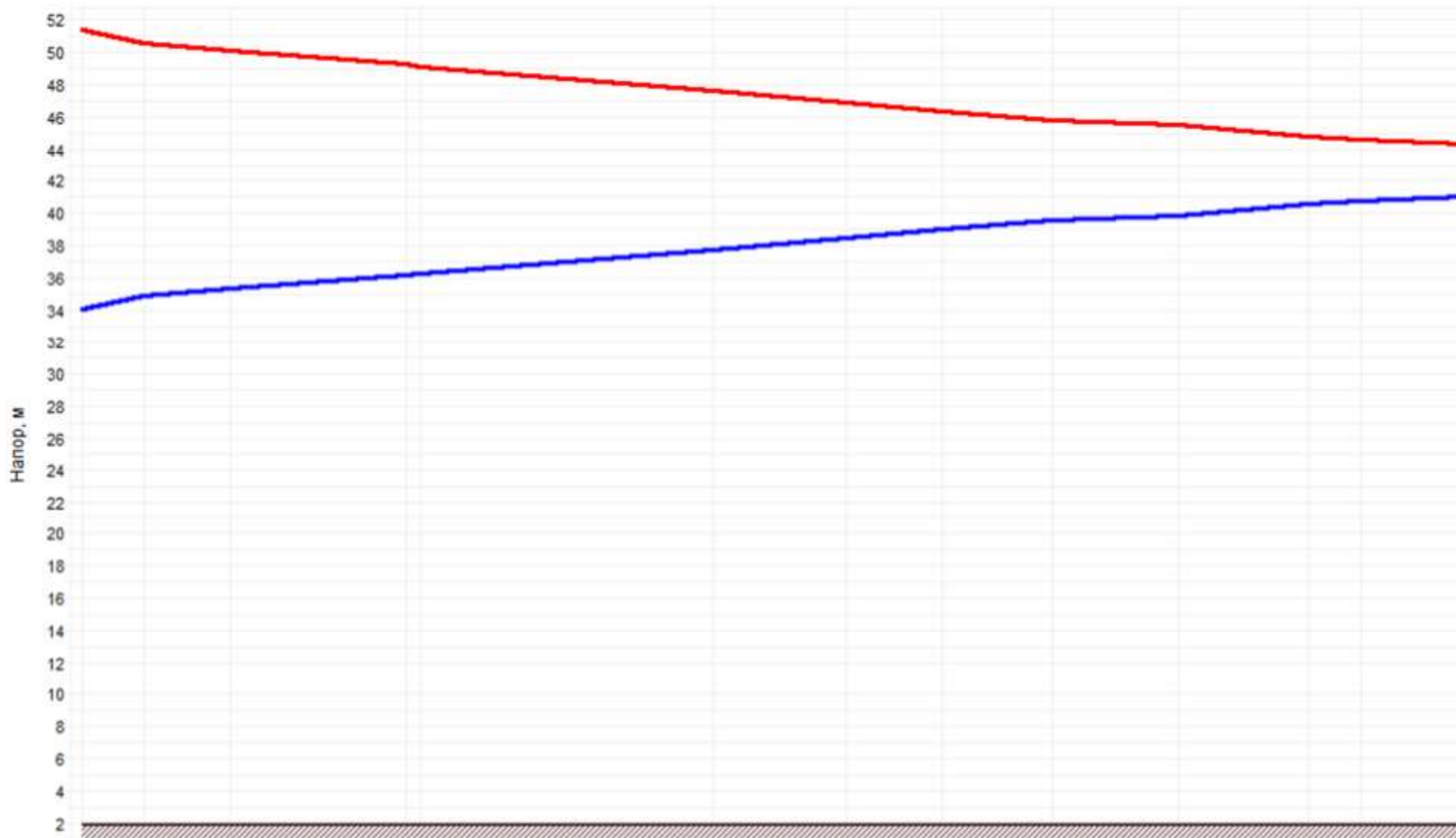
Рисунок 2.46 –График гидравлических режимов рассматриваемого теплопровода
