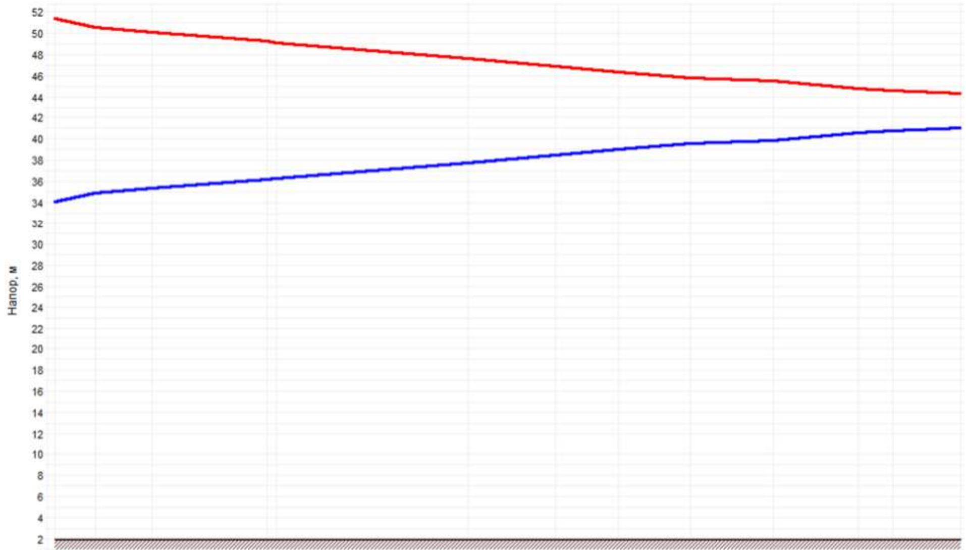
Рисунок 1.46 –График гидравлических режимов рассматриваемого теплопровода
