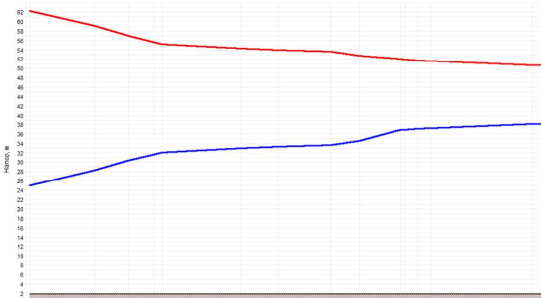
Рисунок 1.40 –График гидравлических режимов рассматриваемого теплопровода
