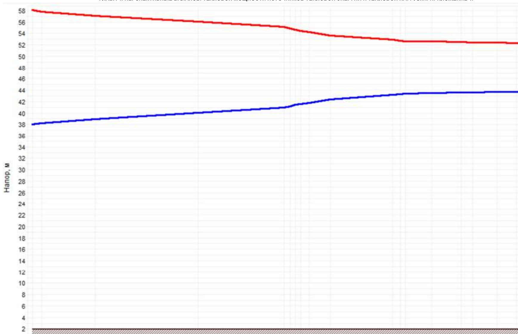
Рисунок 3.42 –График гидравлических режимов рассматриваемого теплопровода
