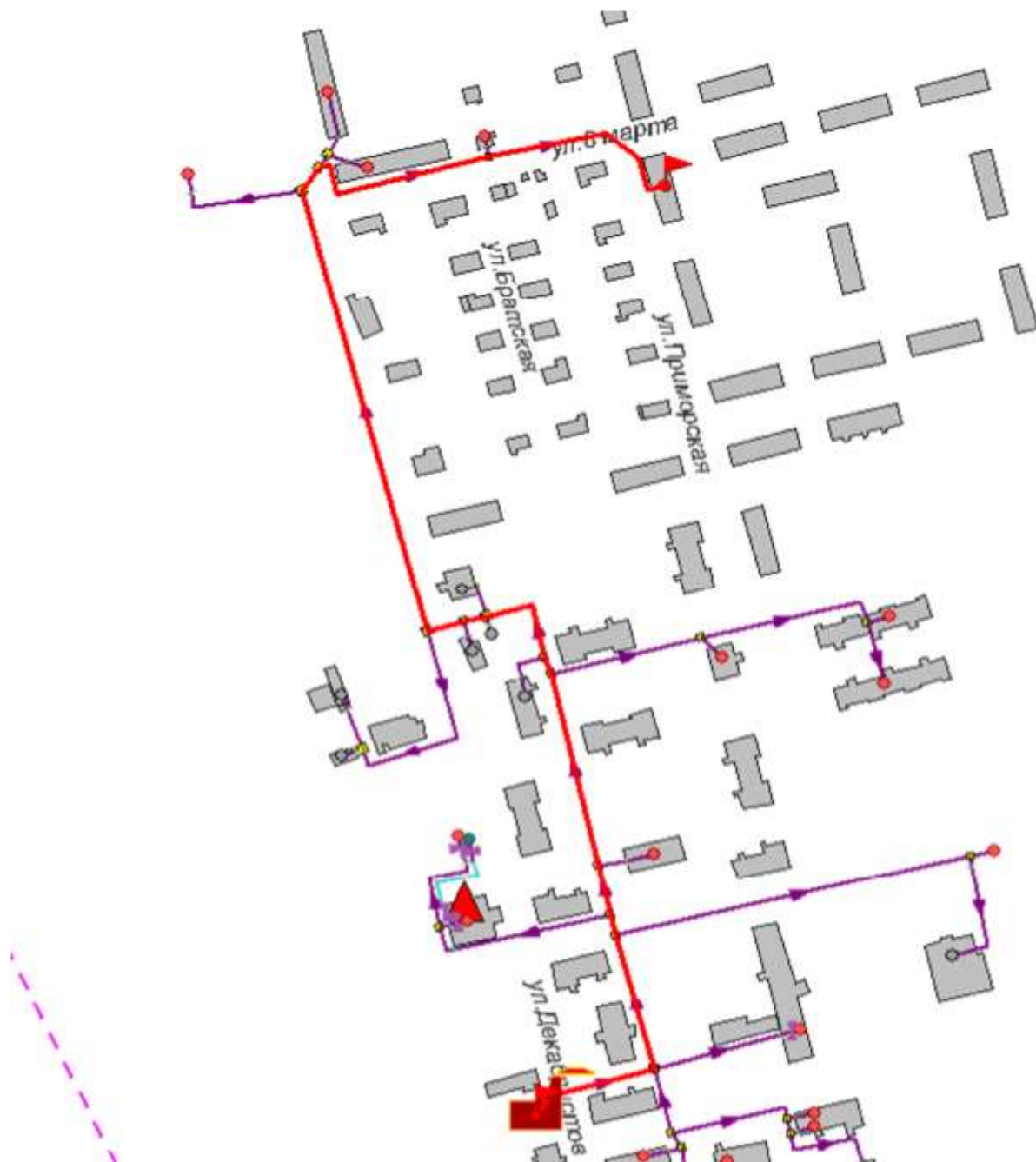
Рисунок 2.63 -Расчетный путь теплоносителя от котельной до Приморская,16
