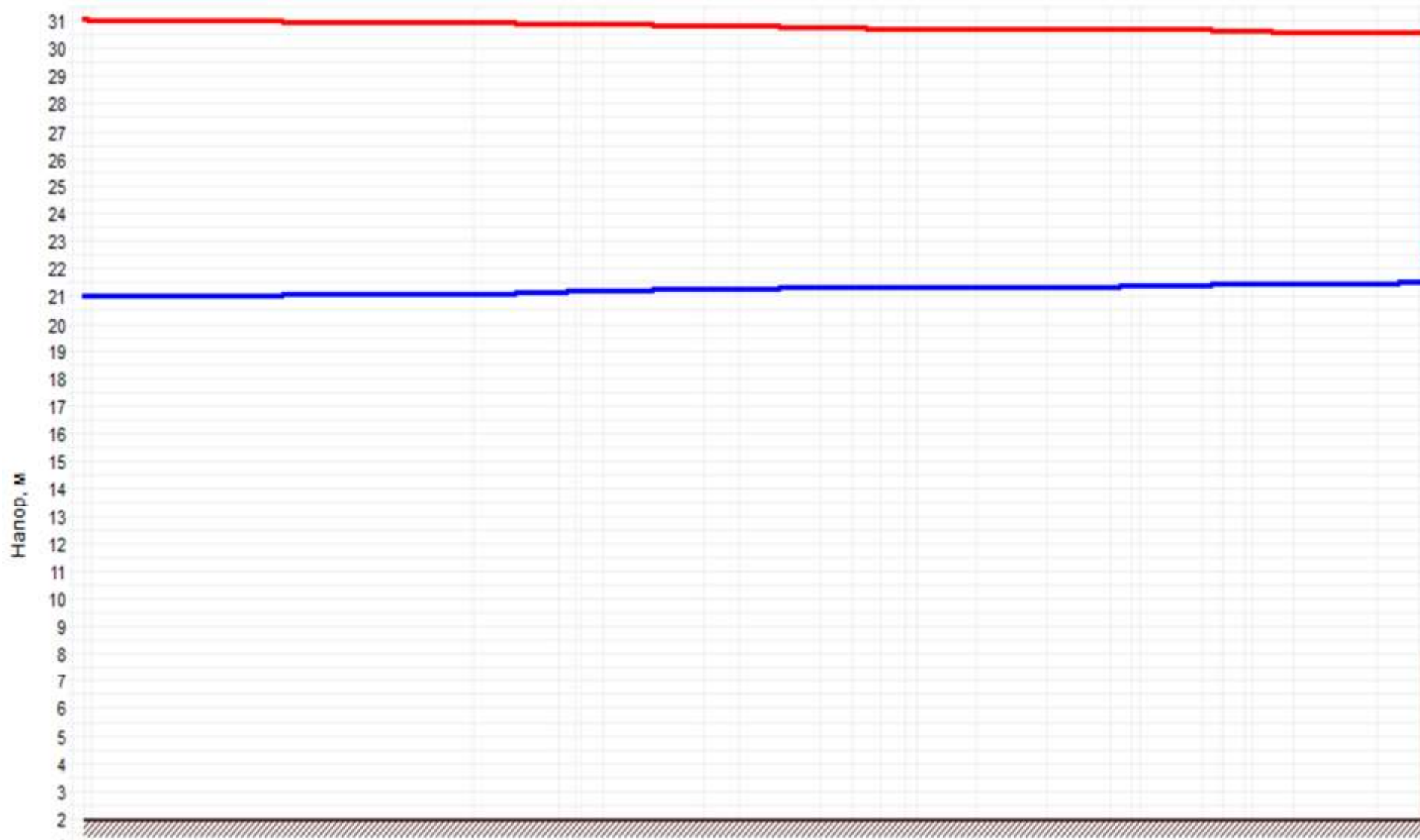
Рисунок 2.96 –График гидравлических режимов рассматриваемого теплопровода
