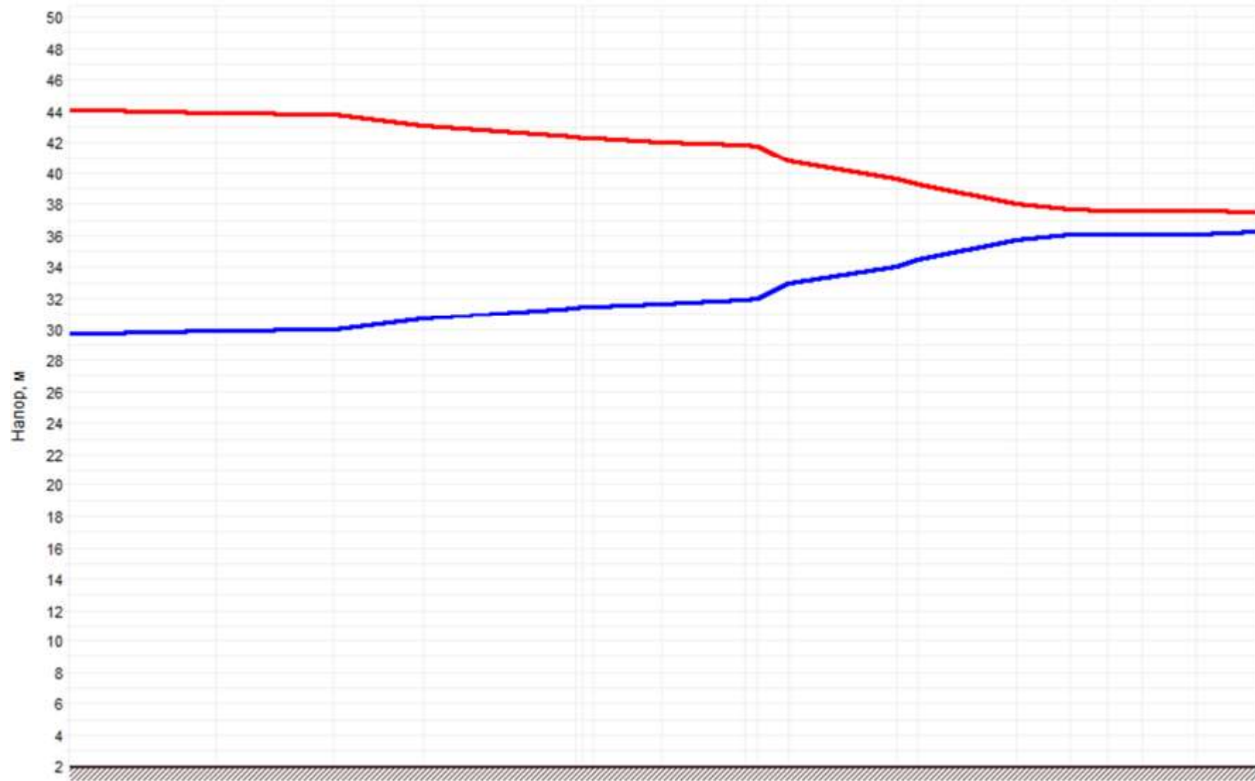
Рисунок 2.86 –График гидравлических режимов рассматриваемого теплопровода
