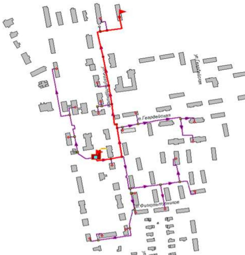
Рисунок 1.71 -Расчетный путь теплоносителя от котельной до Петрова,9
