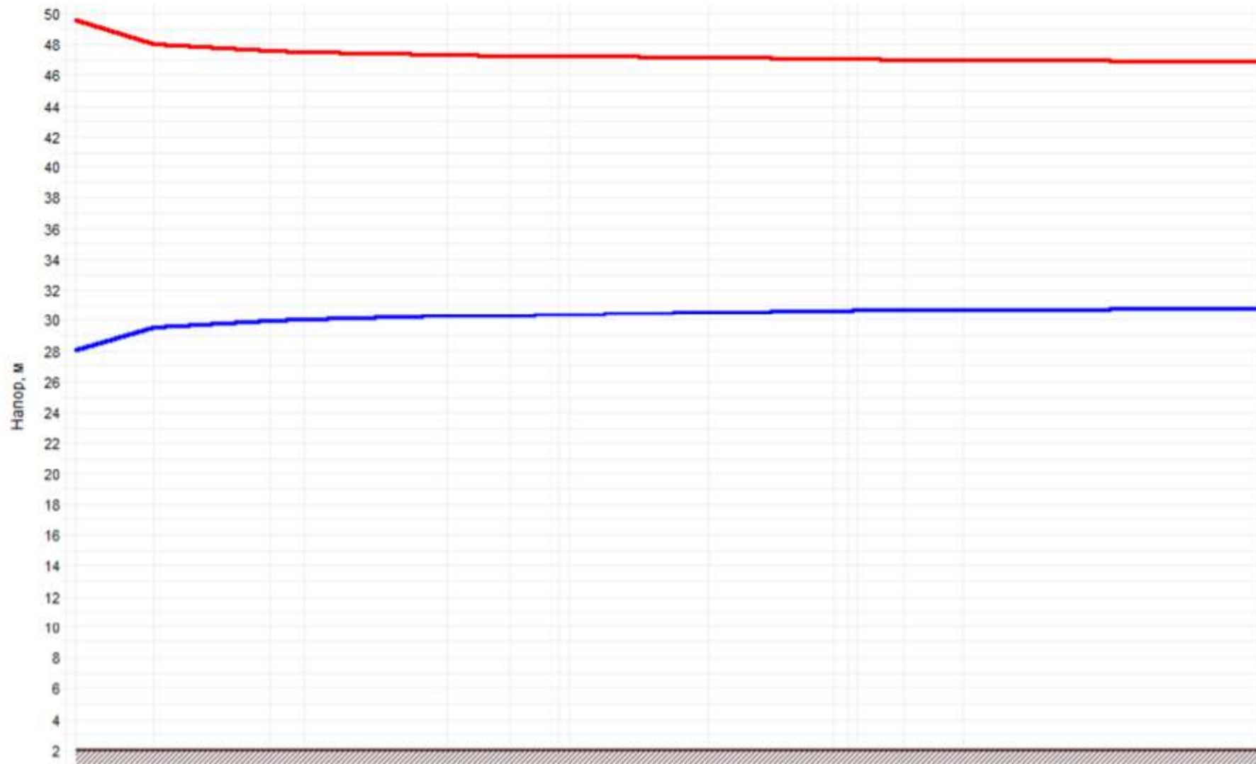
Рисунок 3.48 –График гидравлических режимов рассматриваемого теплопровода
