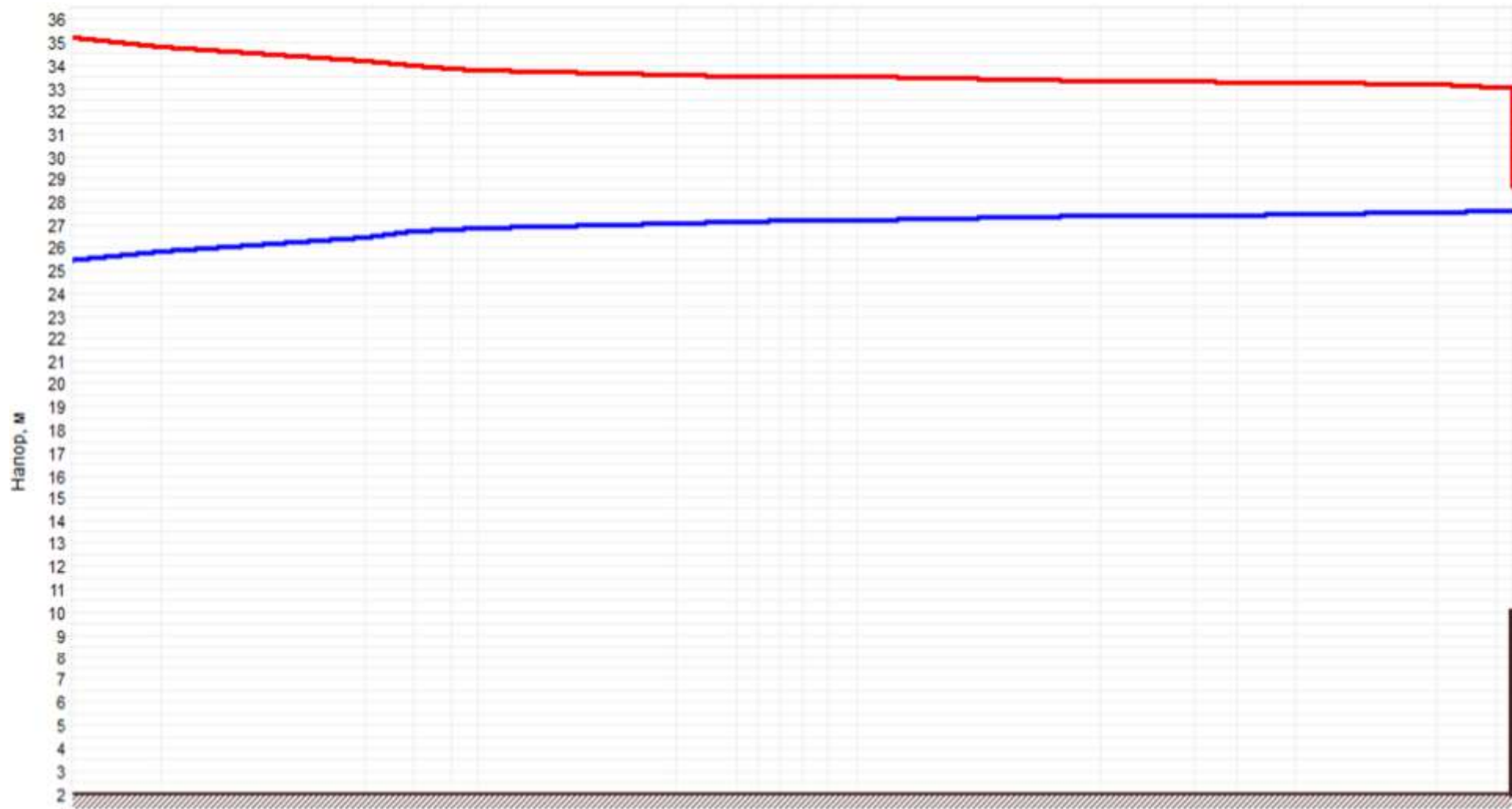
Рисунок 1.66 –График гидравлических режимов рассматриваемого теплопровода
