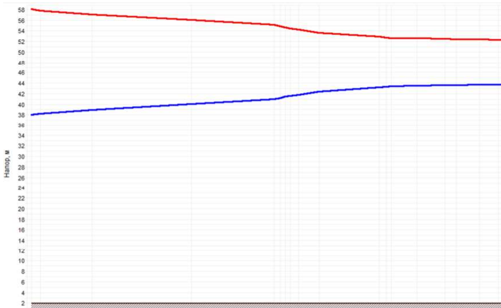
Рисунок 1.42 –График гидравлических режимов рассматриваемого теплопровода
