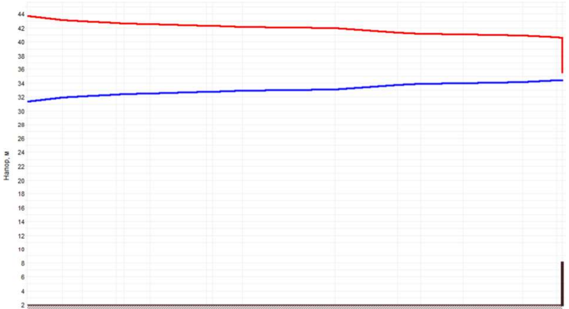
Рисунок 3.80 –График гидравлических режимов рассматриваемого теплопровода
