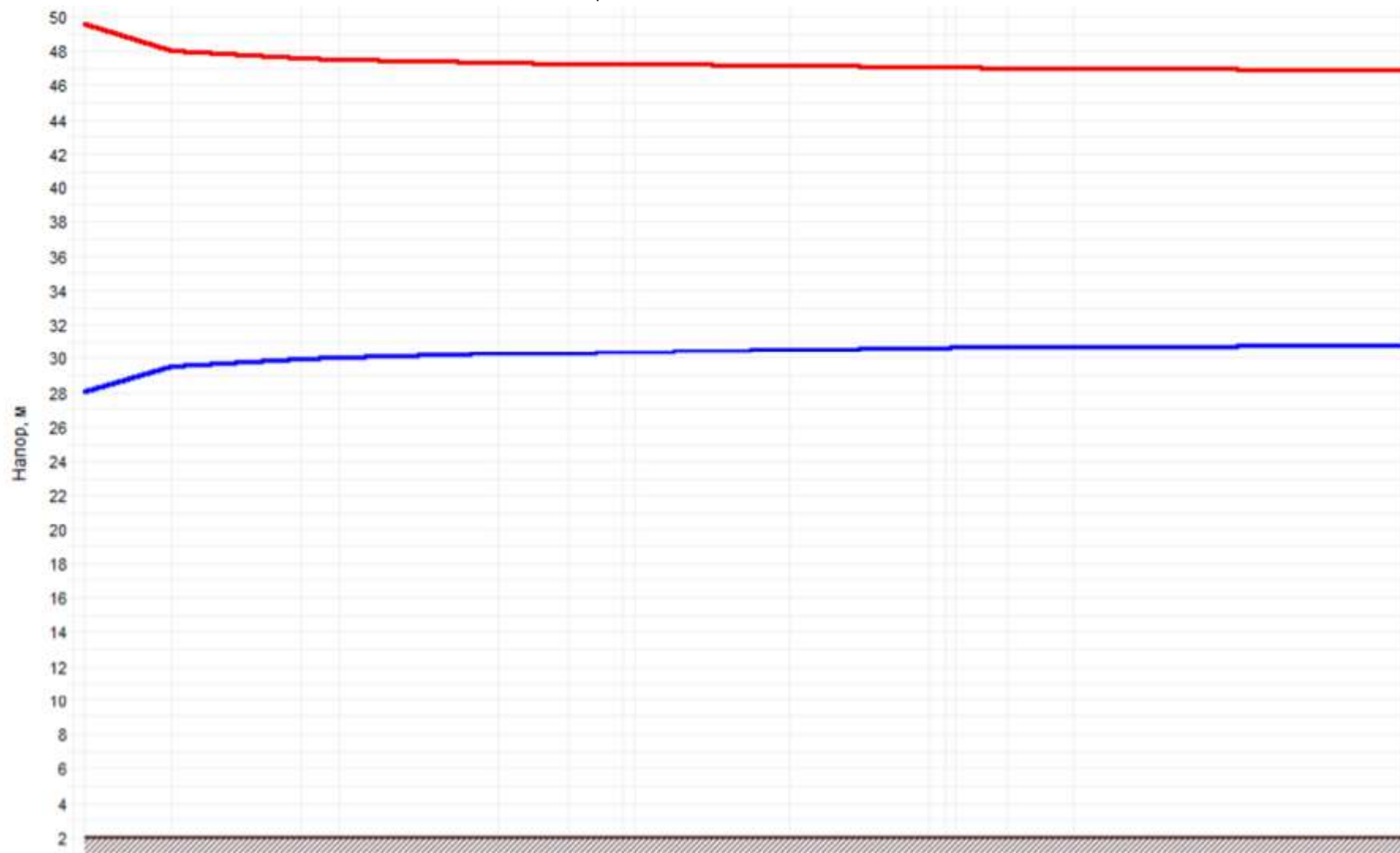
Рисунок 2.48 –График гидравлических режимов рассматриваемого теплопровода
