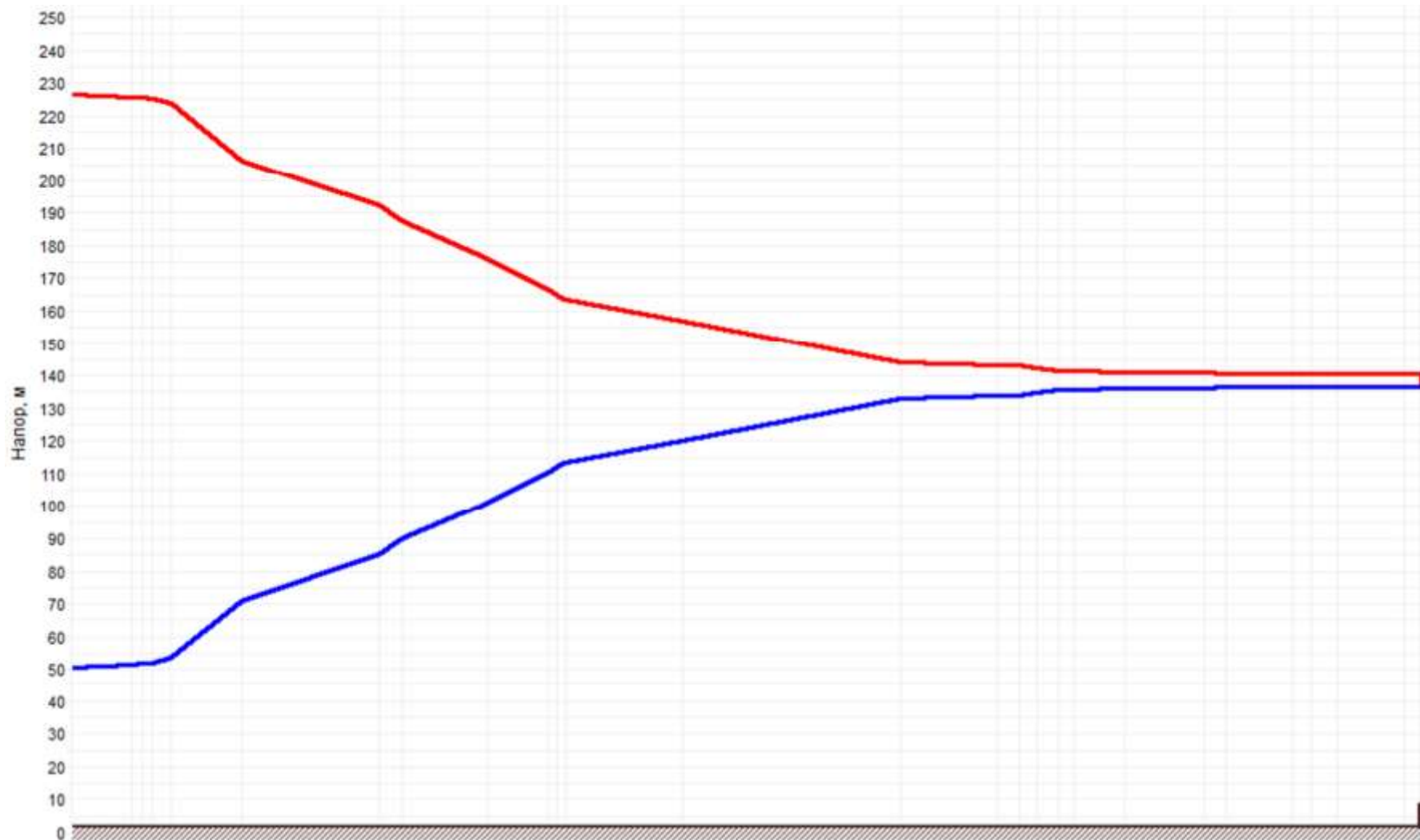
Рисунок 3.90 –График гидравлических режимов рассматриваемого теплопровода
