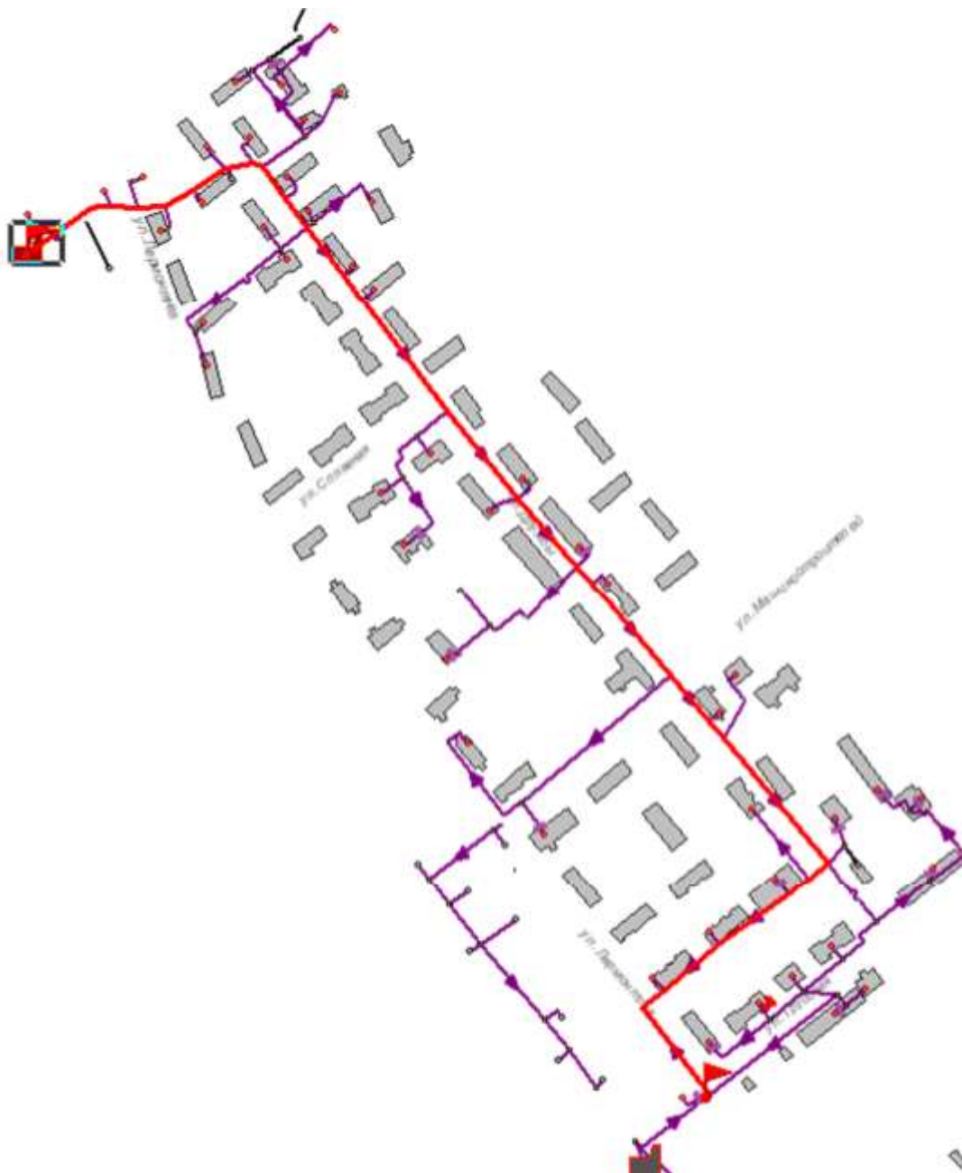
Рисунок 2.33 -Расчетный путь теплоносителя котельной до Лермонтова 23, стр.20
