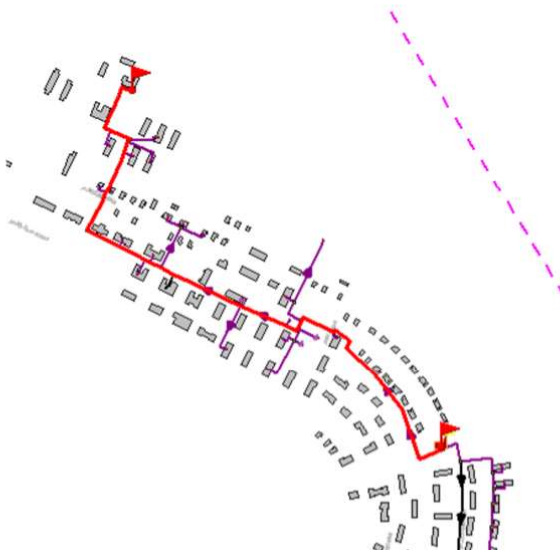
Рисунок 1.95 -Расчетный путь теплоносителя котельной до Карская,15,амбулатория 29л/з
