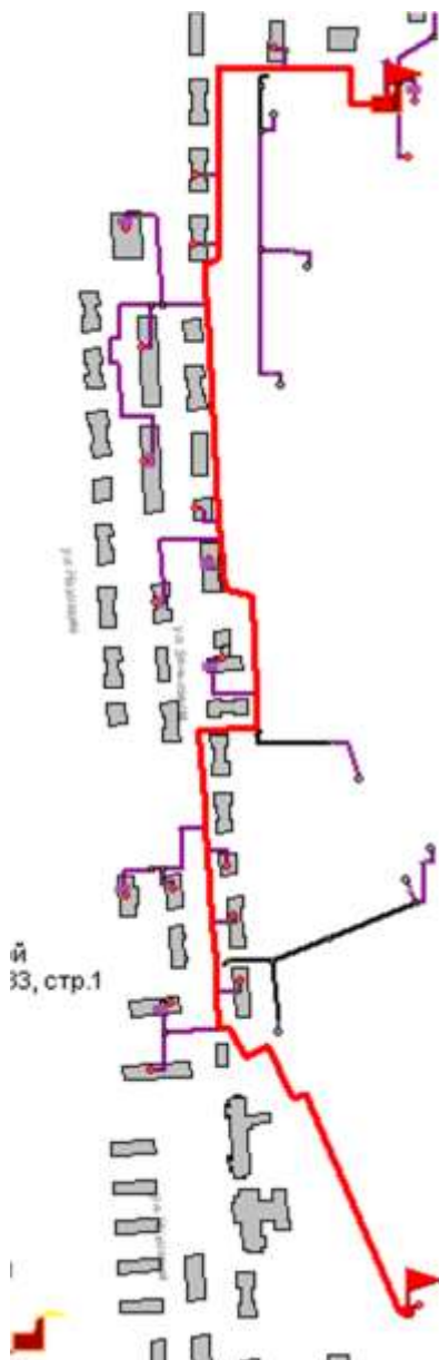
Рисунок 3.29 -Расчетный путь теплоносителя котельной до Пластмассового завода
