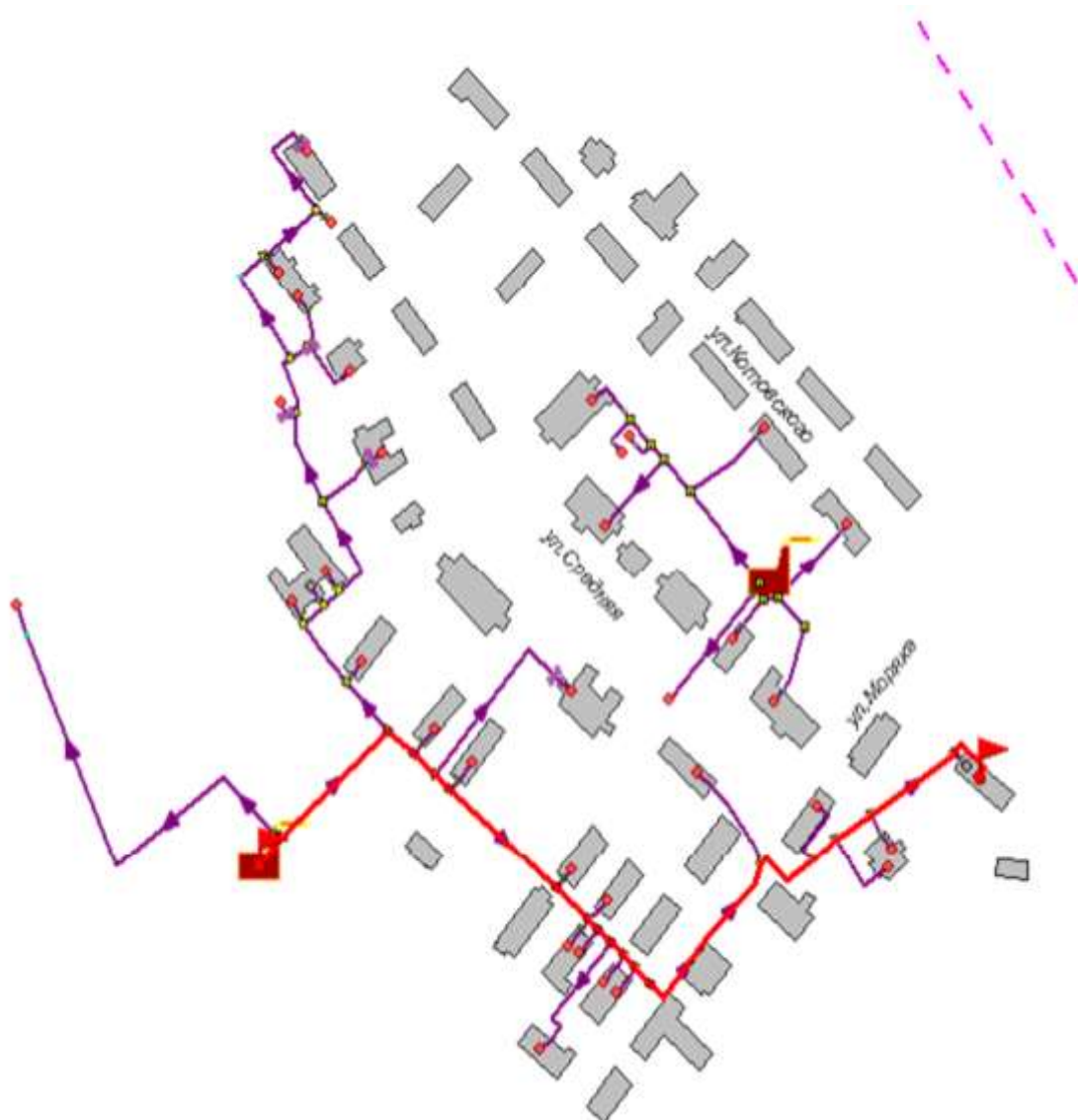
Рисунок 1.65 -Расчетный путь теплоносителя котельной до Моряка,1
