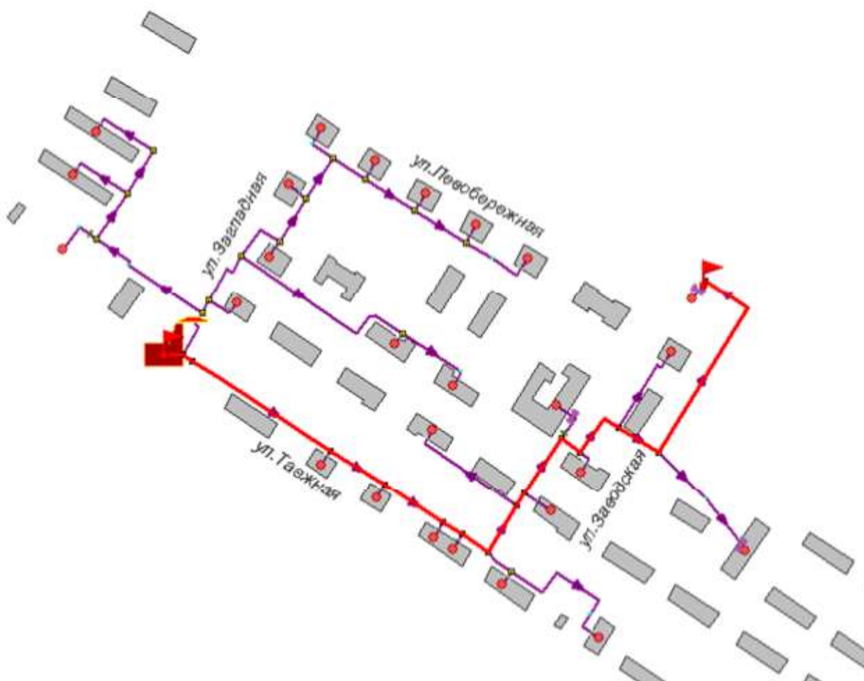
Рисунок 2.57 -Расчетный путь теплоносителя котельной до Турдево,ПЧ-70
