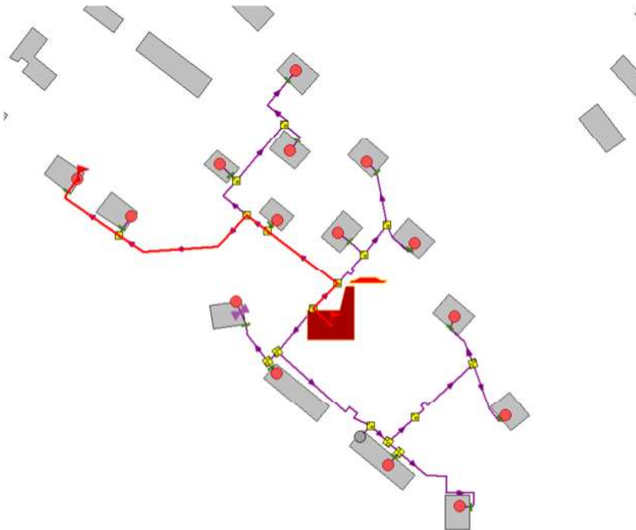
Рисунок 1.19 -Расчетный путь теплоносителя котельной до Дрейера, 15 к.3
