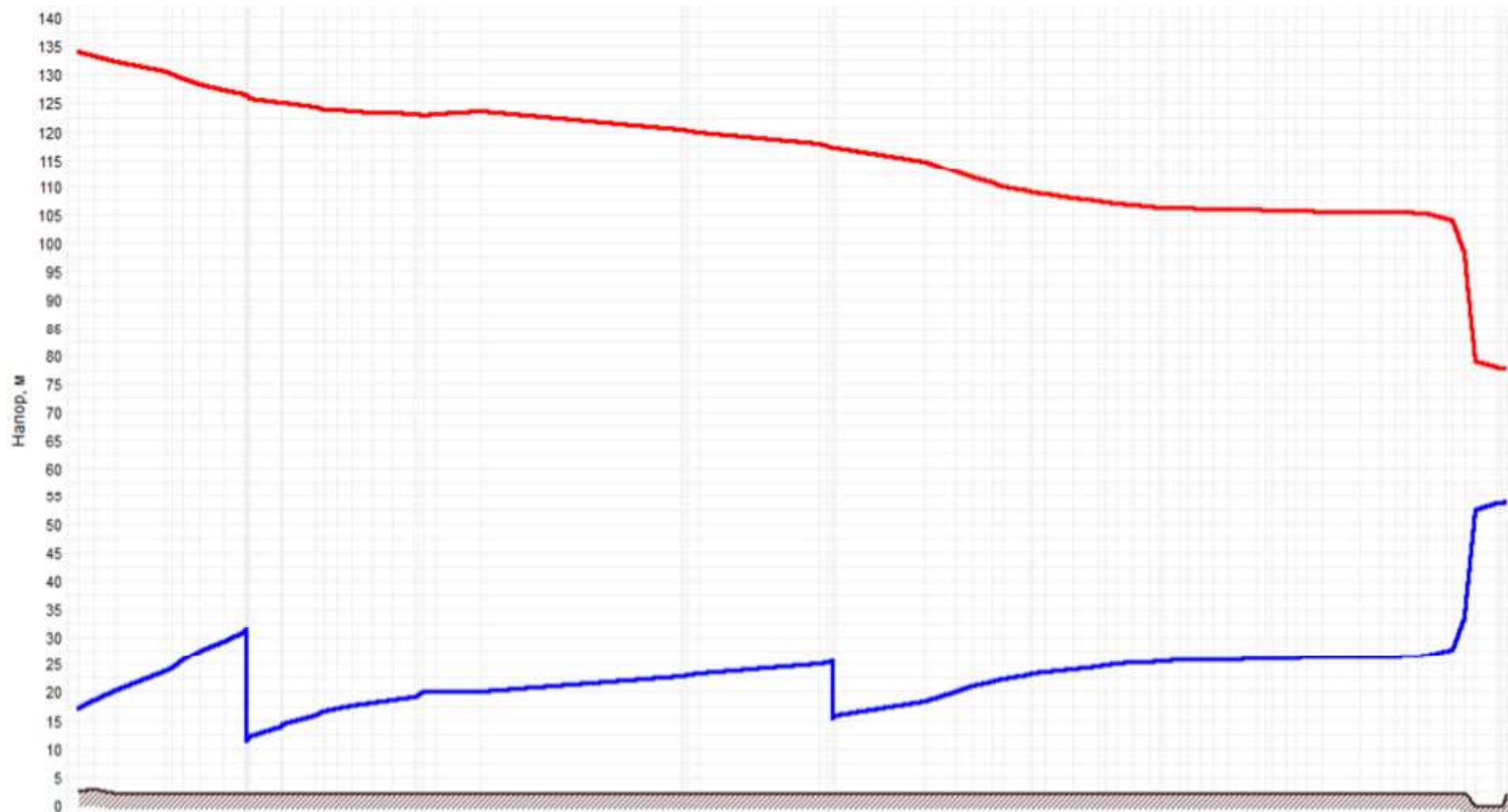
Рисунок 3.4 –График гидравлических режимов рассматриваемого теплопровода
