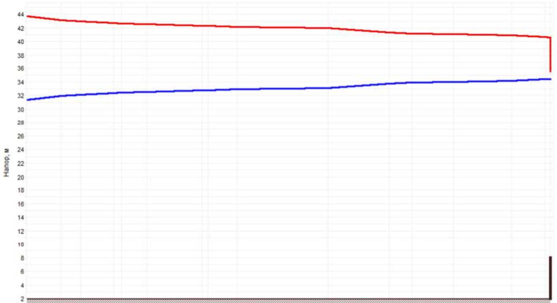
Рисунок 1.80 –График гидравлических режимов рассматриваемого теплопровода
