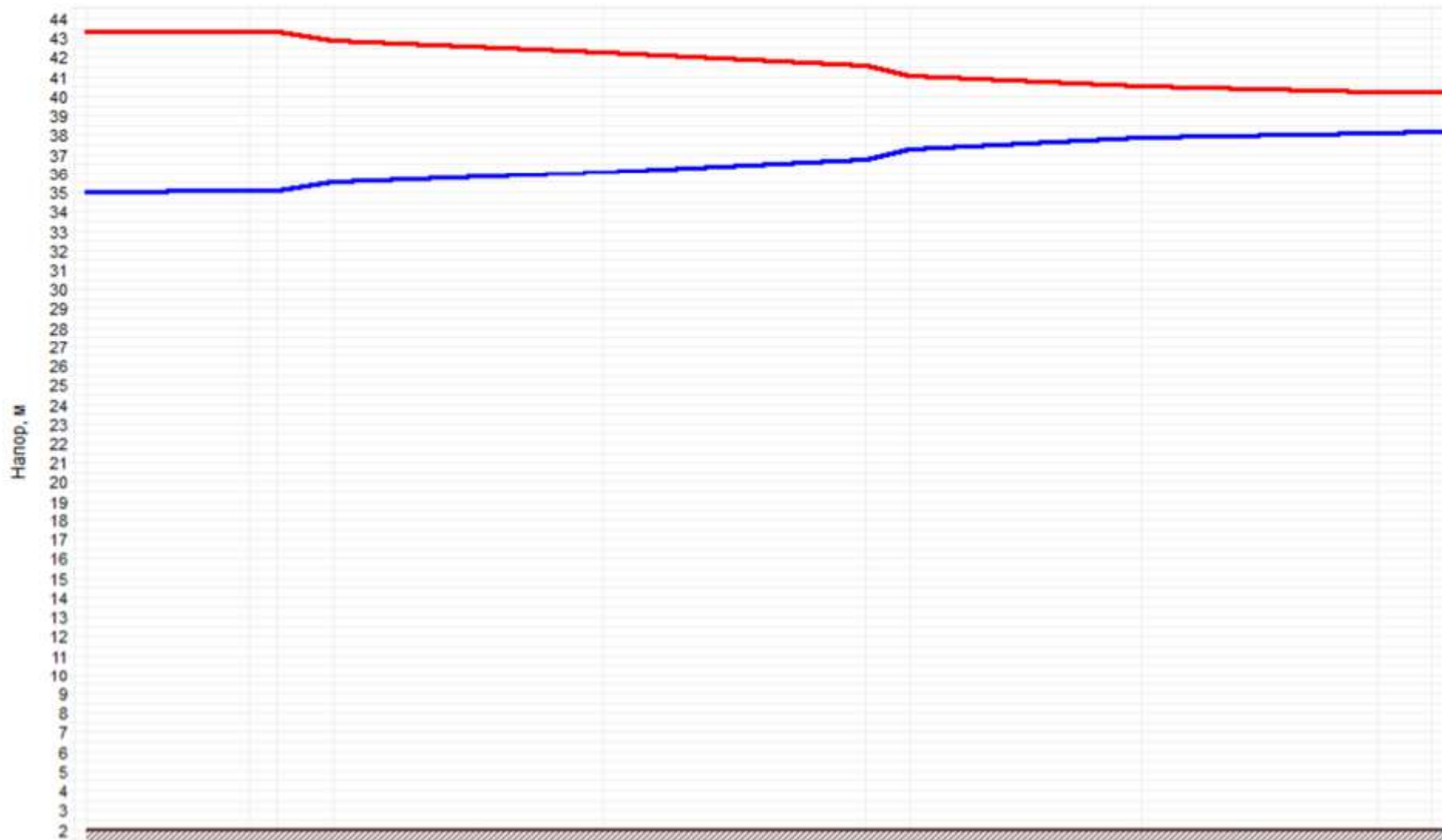
Рисунок 2.52 –График гидравлических режимов рассматриваемого теплопровода
