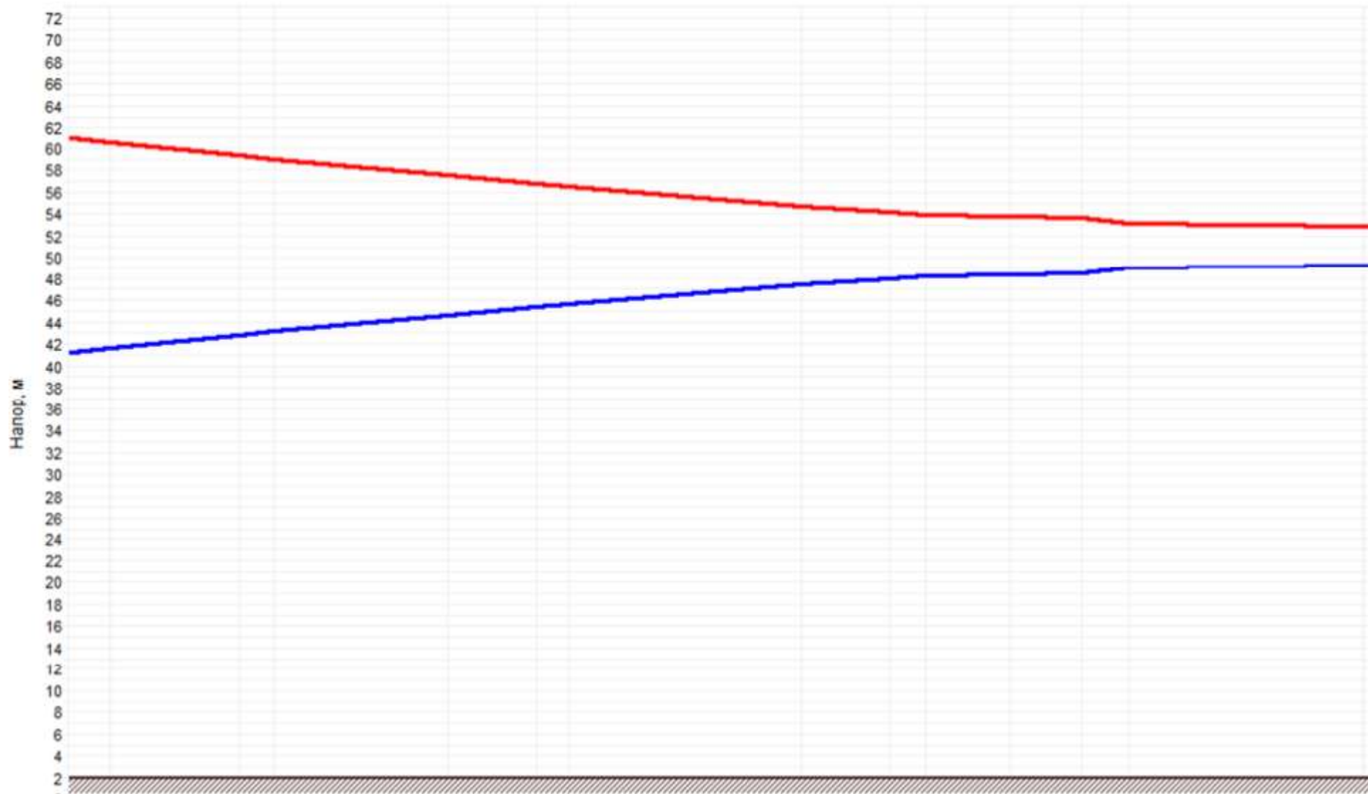
Рисунок 2.34 –График гидравлических режимов рассматриваемого теплопровода
