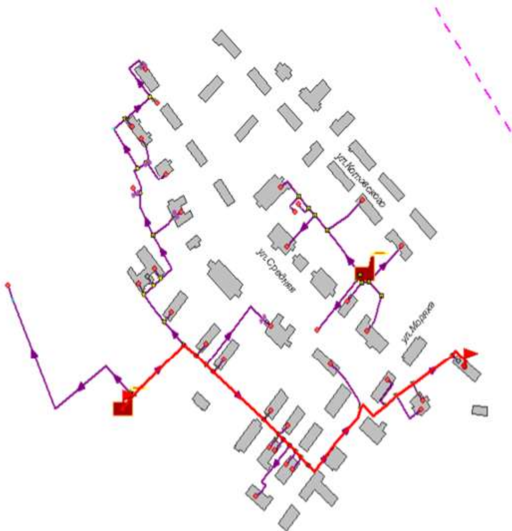
Рисунок 3.65 -Расчетный путь теплоносителя котельной до Моряка,1
