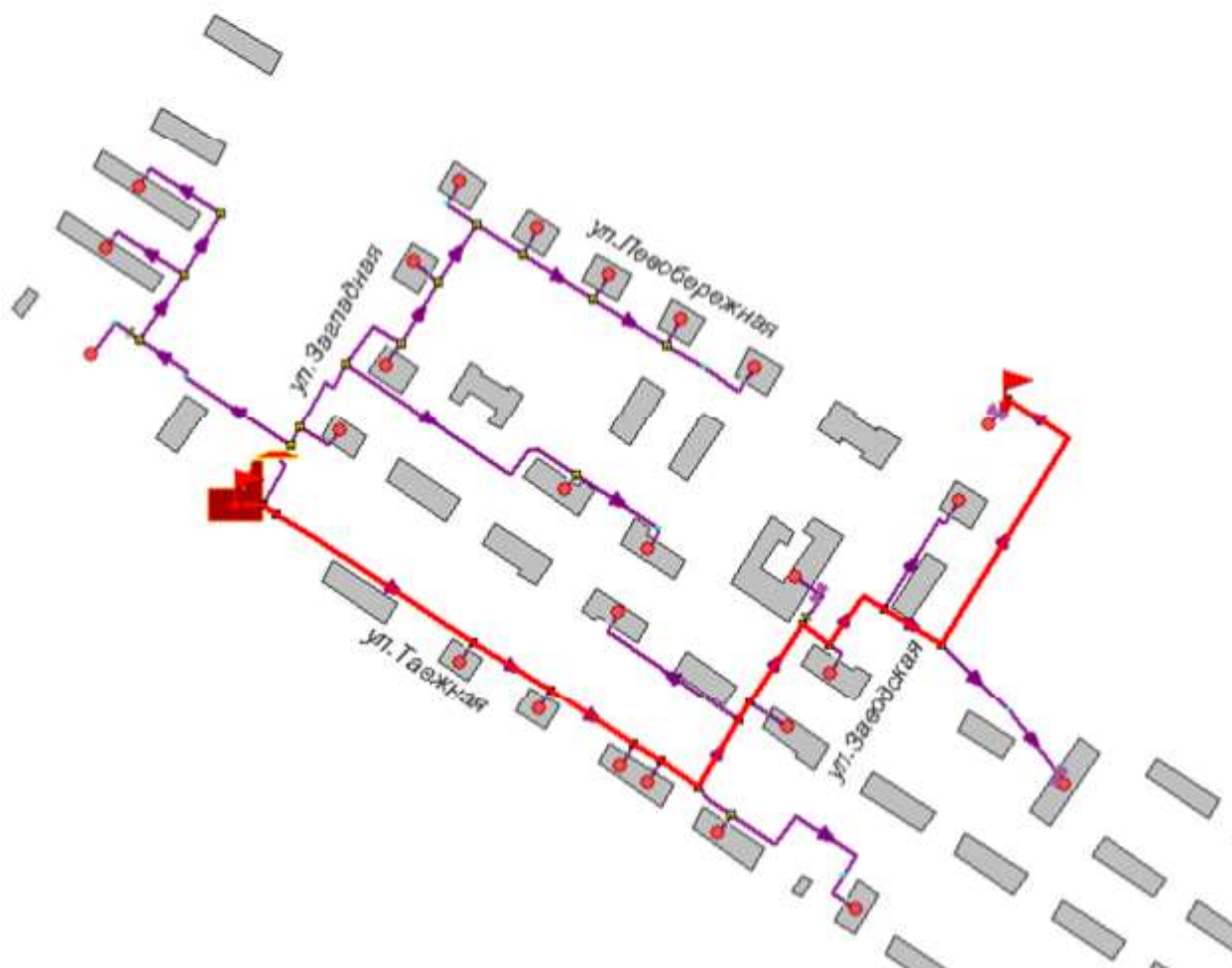
Рисунок 1.57 -Расчетный путь теплоносителя котельной до Турдеево,ПЧ-70
