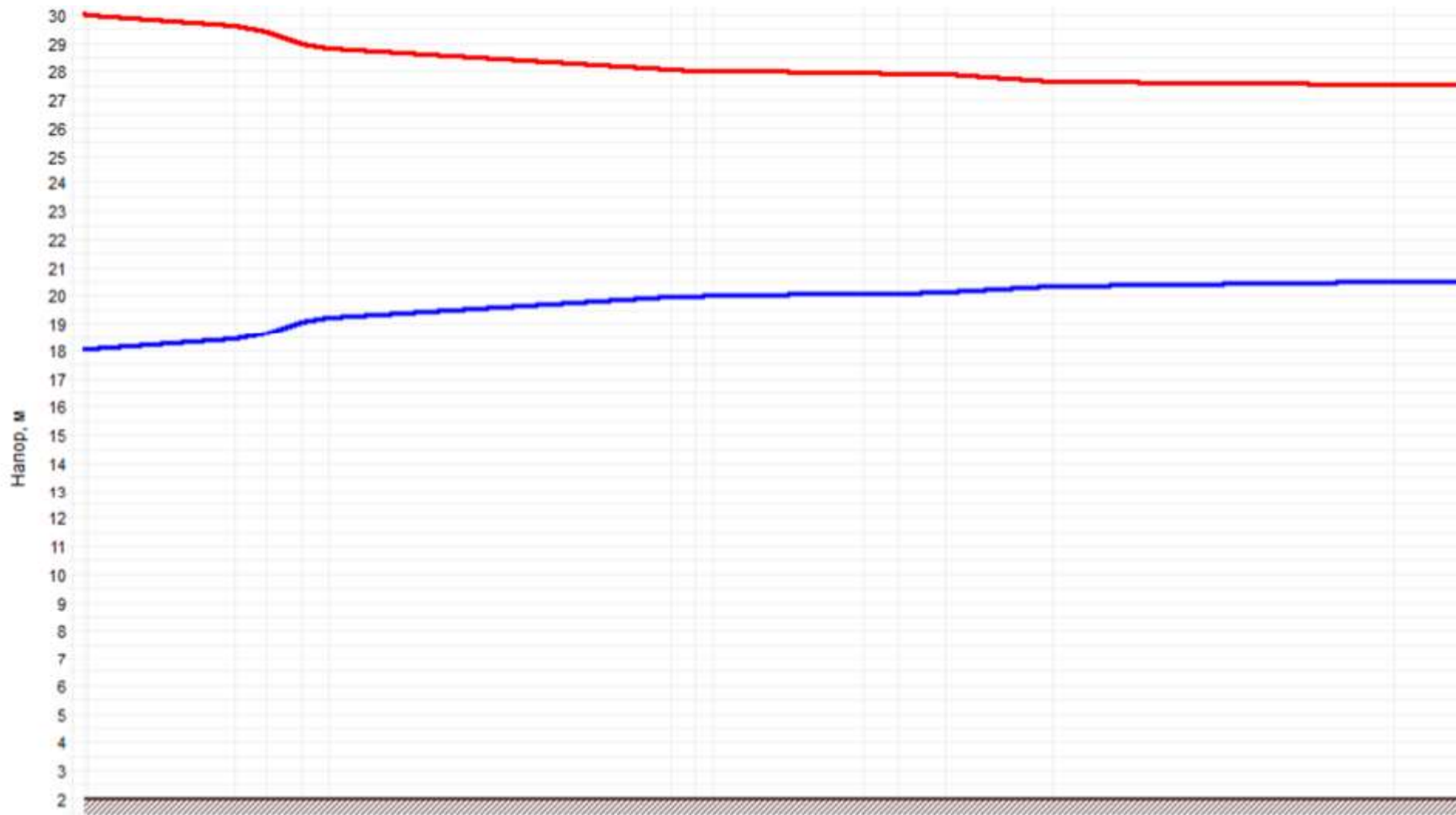
Рисунок 1.74 –График гидравлических режимов рассматриваемого теплопровода
