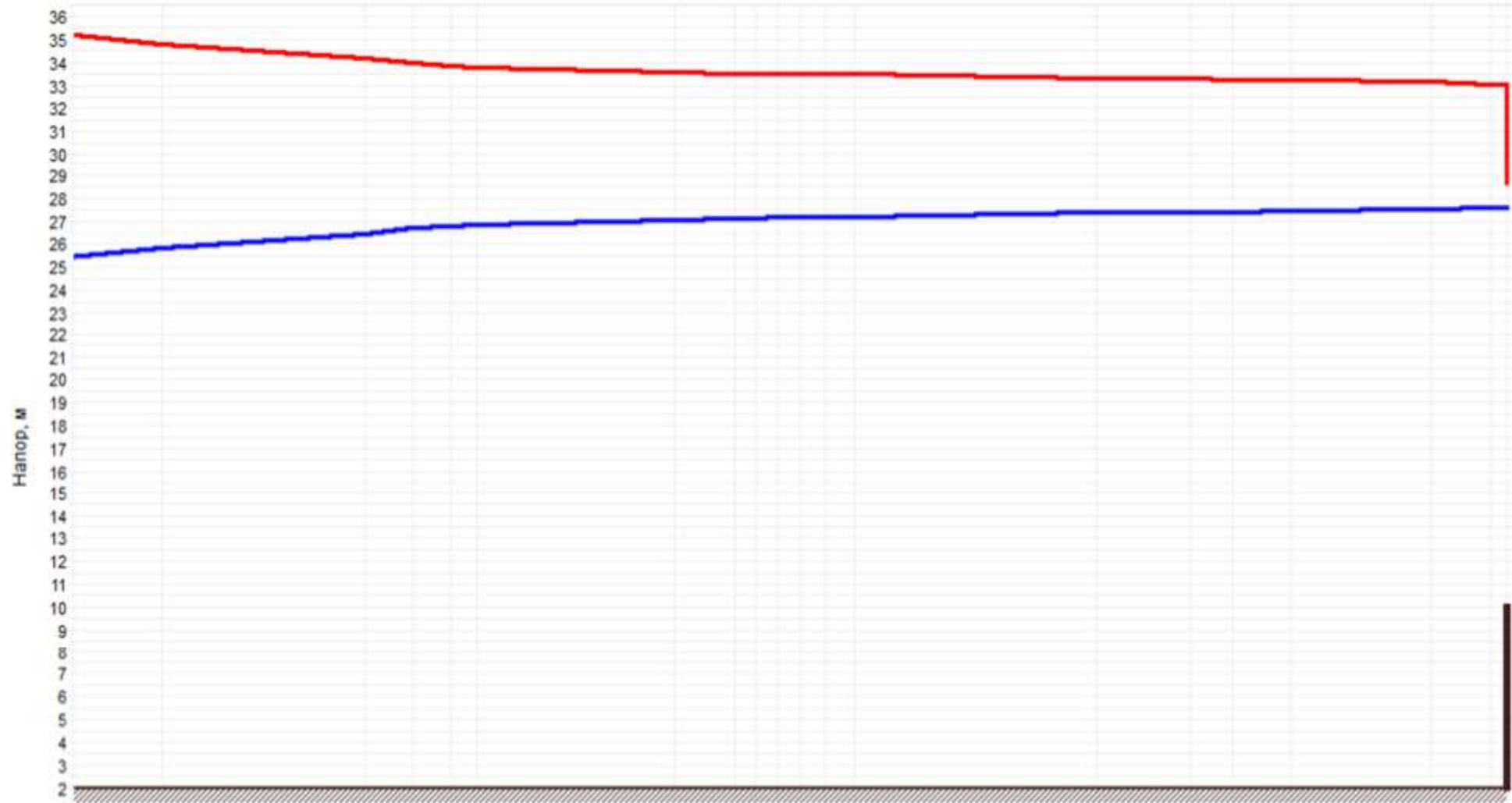
Рисунок 2.66 –График гидравлических режимов рассматриваемого теплопровода
