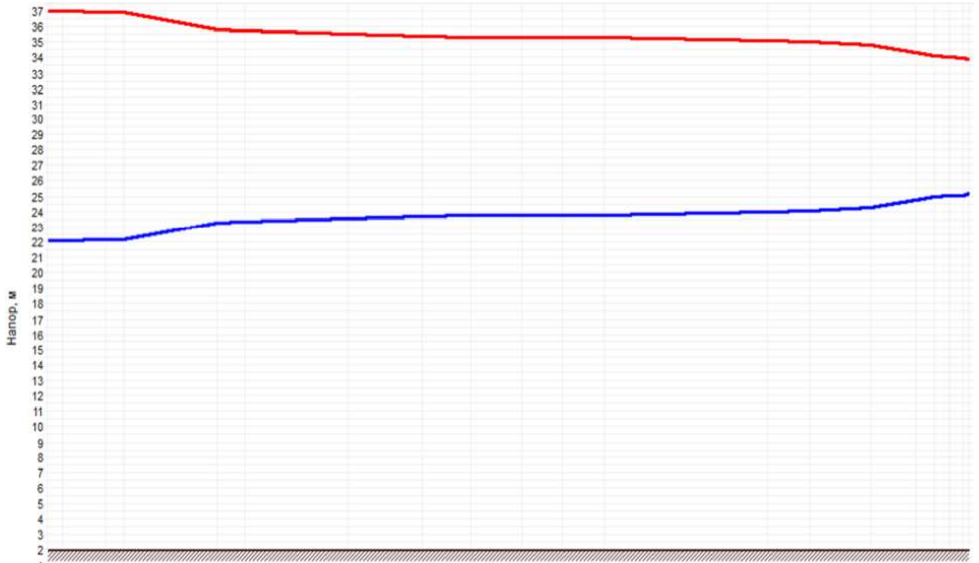
Рисунок 3.14 –График гидравлических режимов рассматриваемого теплопровода
