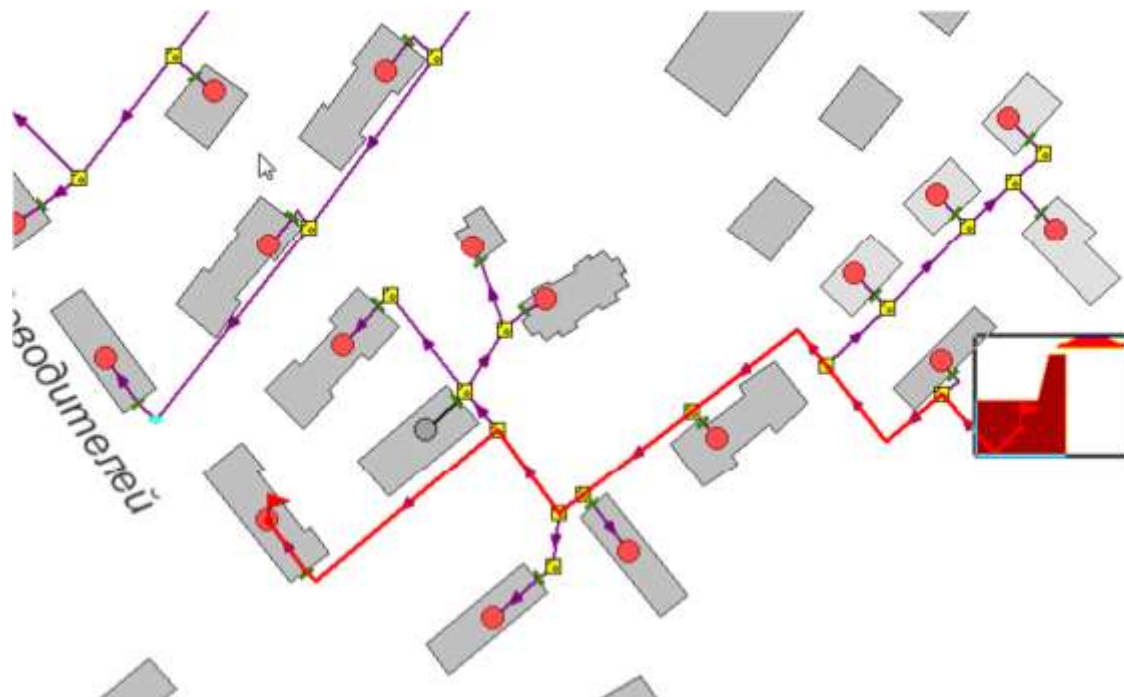
Рисунок 3.43 -Расчетный путь теплоносителя котельной до Речников,29
