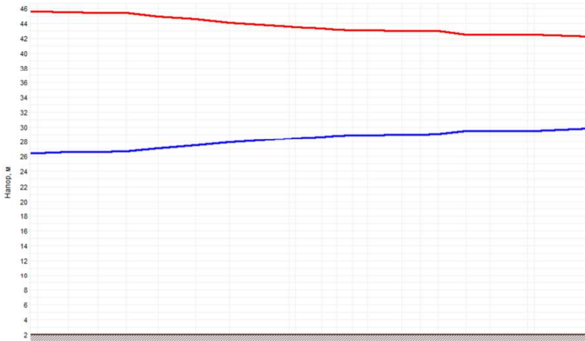
Рисунок 1.16 –График гидравлических режимов рассматриваемого теплопровода
