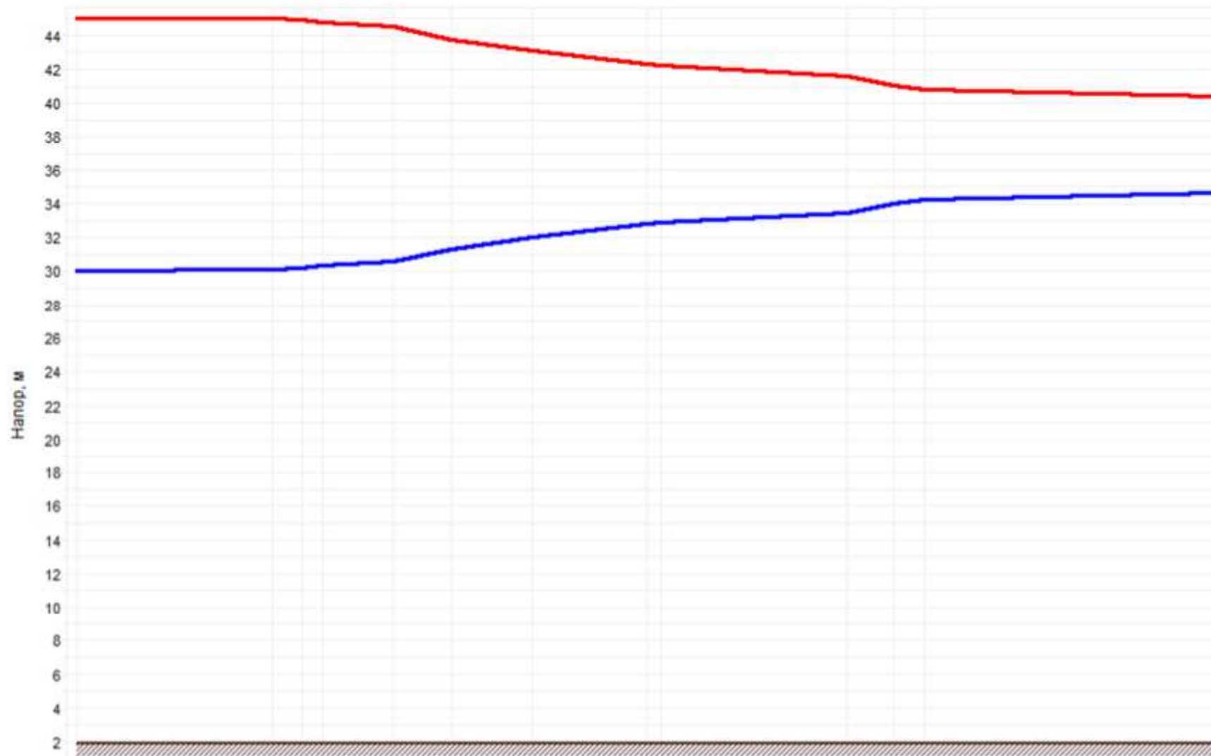
Рисунок 2.82 –График гидравлических режимов рассматриваемого теплопровода
