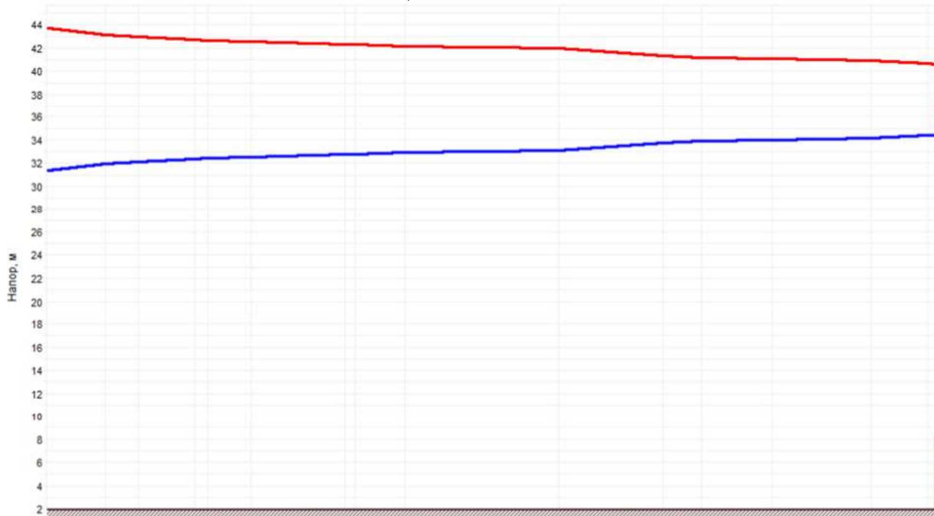
Рисунок 2.80 –График гидравлических режимов рассматриваемого теплопровода
