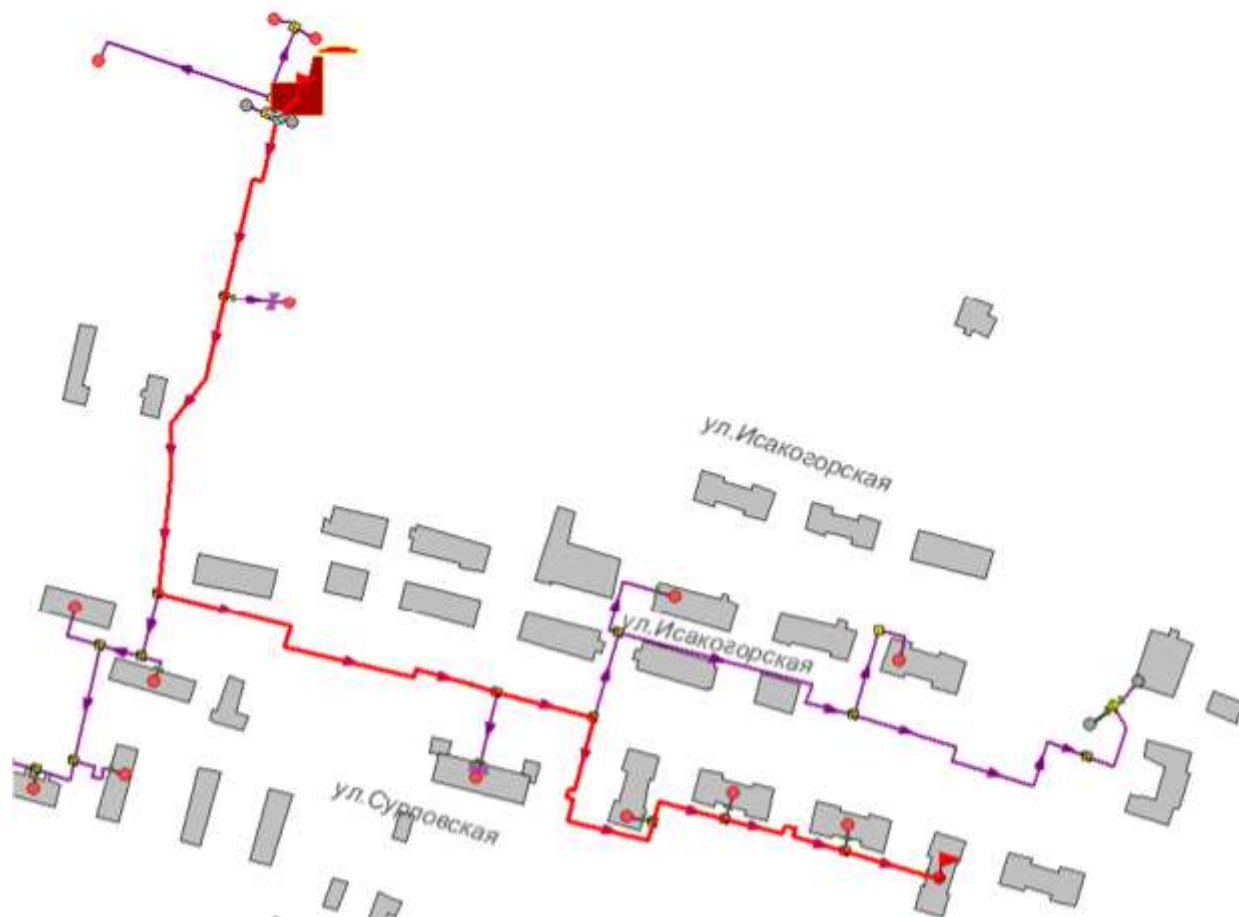
Рисунок 2.17 -Расчетный путь теплоносителя котельной до Сурповской, 20
