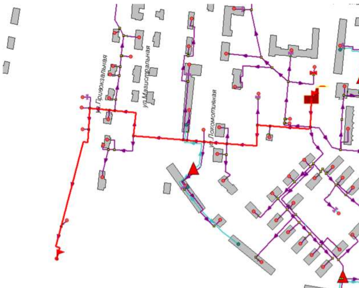
Рисунок 1.47 -Расчетный путь теплоносителя от котельной до Привокзальная, 19
