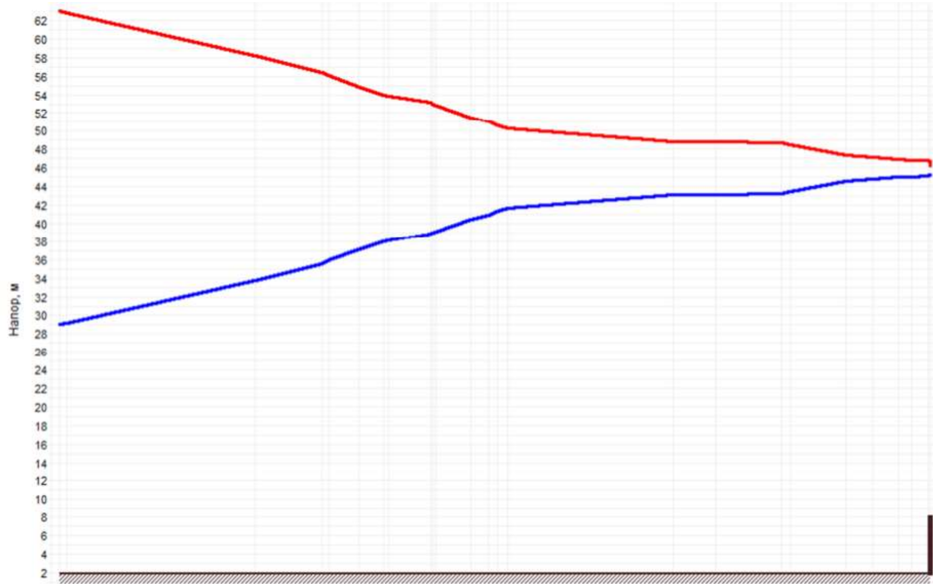
Рисунок 2.28 –График гидравлических режимов рассматриваемого теплопровода
