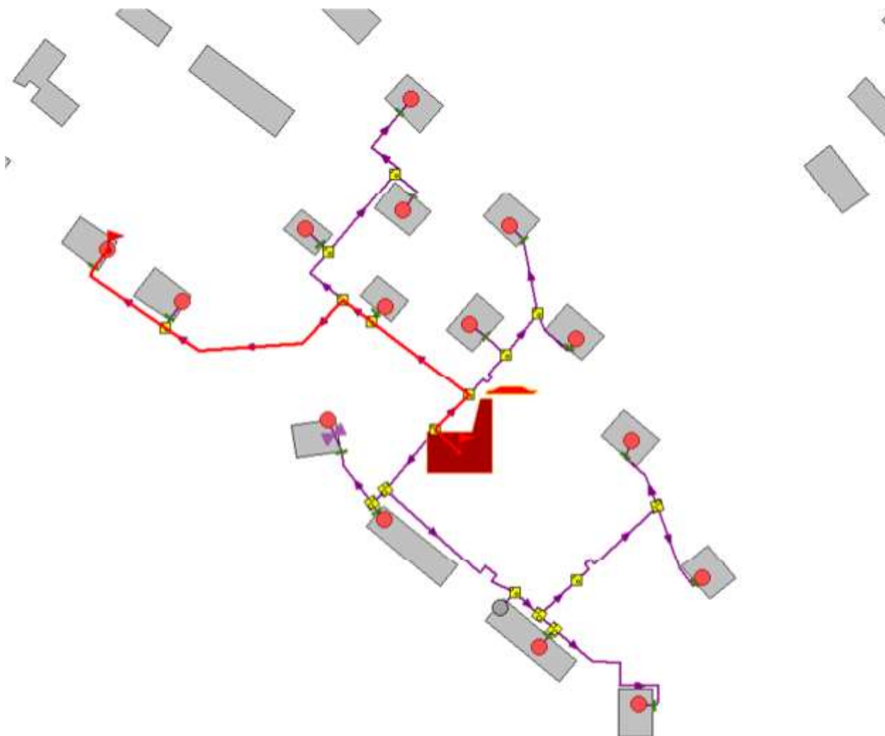
Рисунок 3.19 -Расчетный путь теплоносителя котельной до Дрейера, 15 к.3
