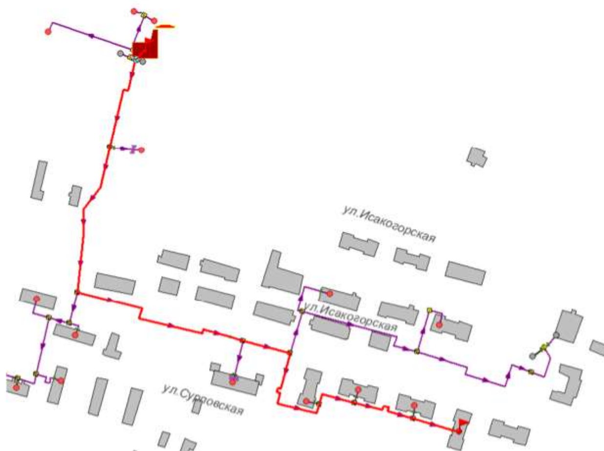
Рисунок 1.17 -Расчетный путь теплоносителя котельной до Сурповской, 20
