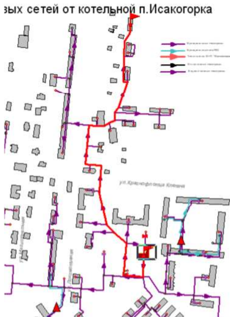
Рисунок 1.49 -Расчетный путь теплоносителя от котельной до Локомотивная,1
