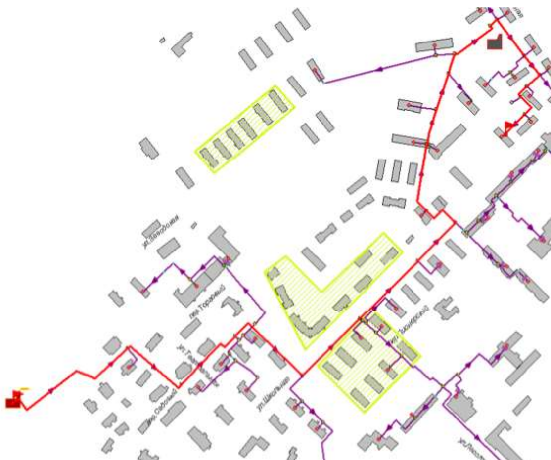
Рисунок 1.85 -Расчетный путь теплоносителя котельной до Школьная,162
