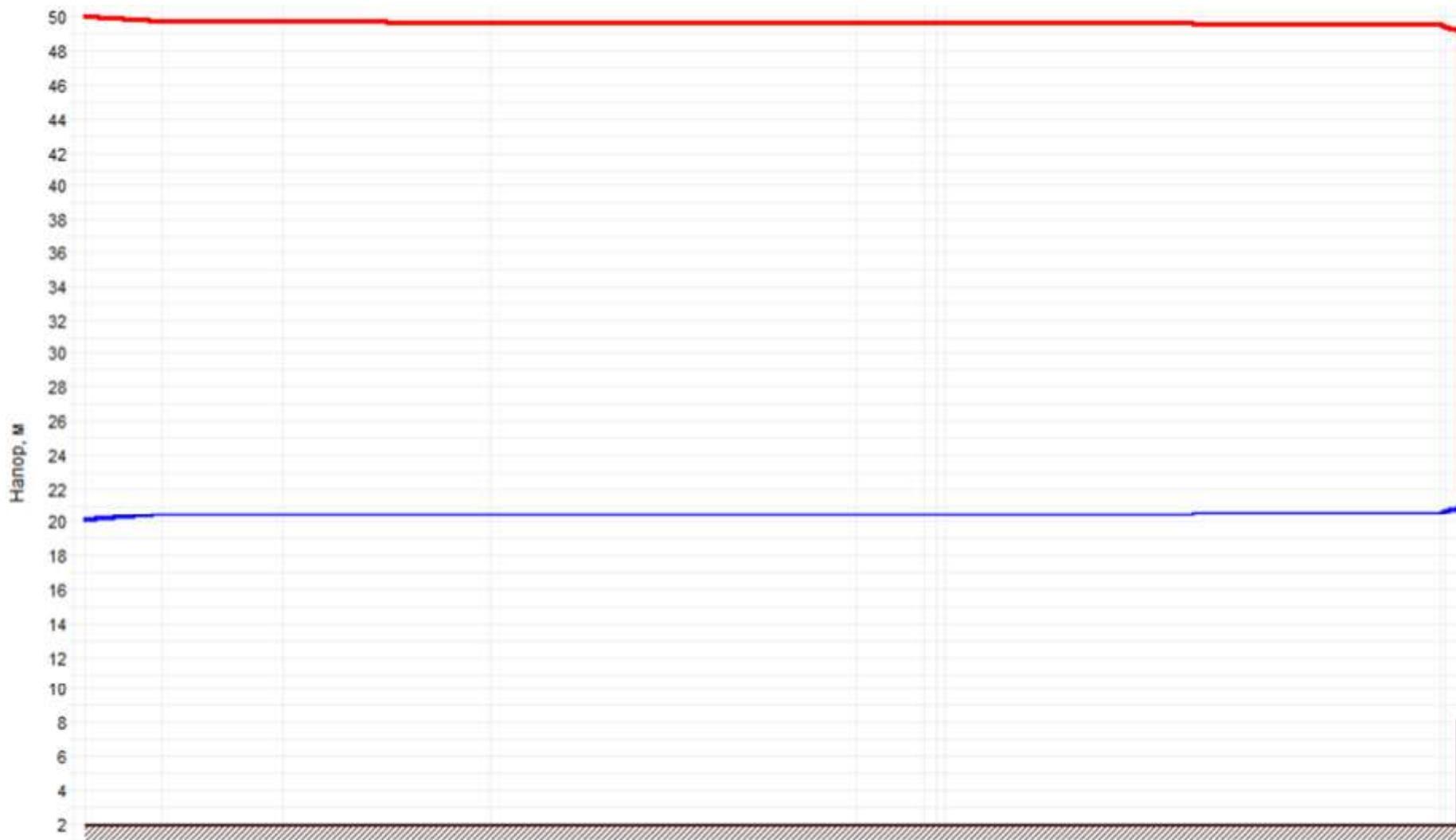
Рисунок 1.94 –График гидравлических режимов рассматриваемого теплопровода
