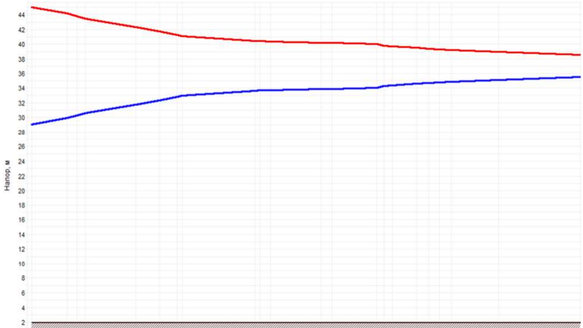
Рисунок 1.30 –График гидравлических режимов рассматриваемого теплопровода
