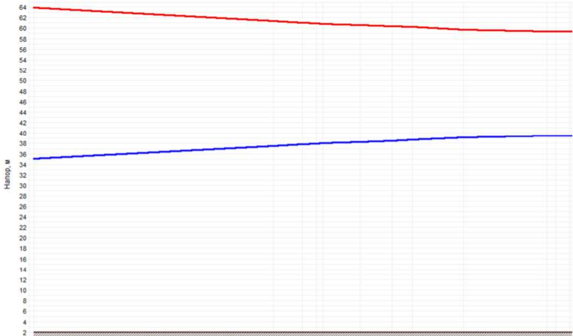
Рисунок 1.36 –График гидравлических режимов рассматриваемого теплопровода
