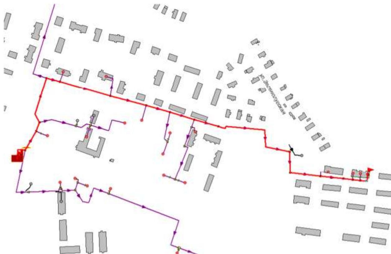
Рисунок 3.13 -Расчетный путь теплоносителя котельной до КЛДК 23, УУ1
