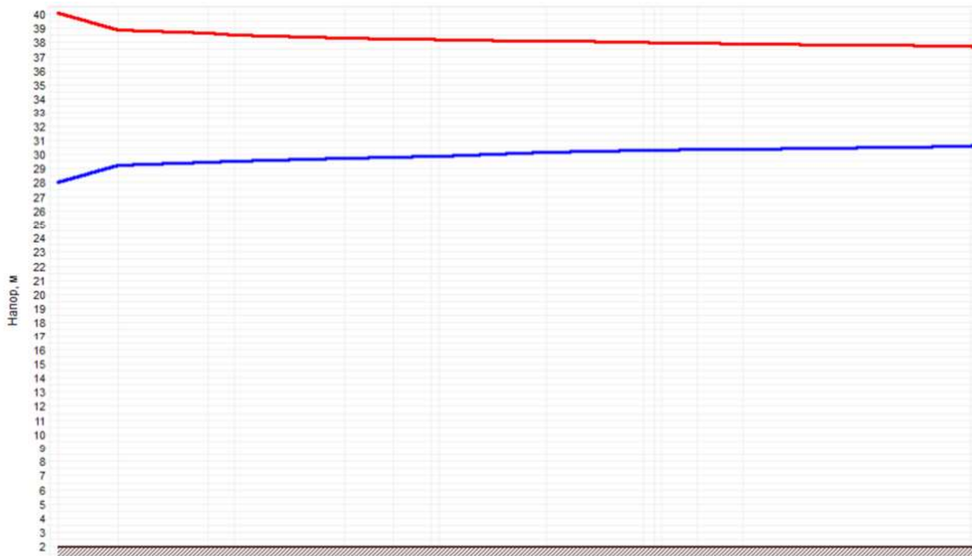
Рисунок 1.48 –График гидравлических режимов рассматриваемого теплопровода
