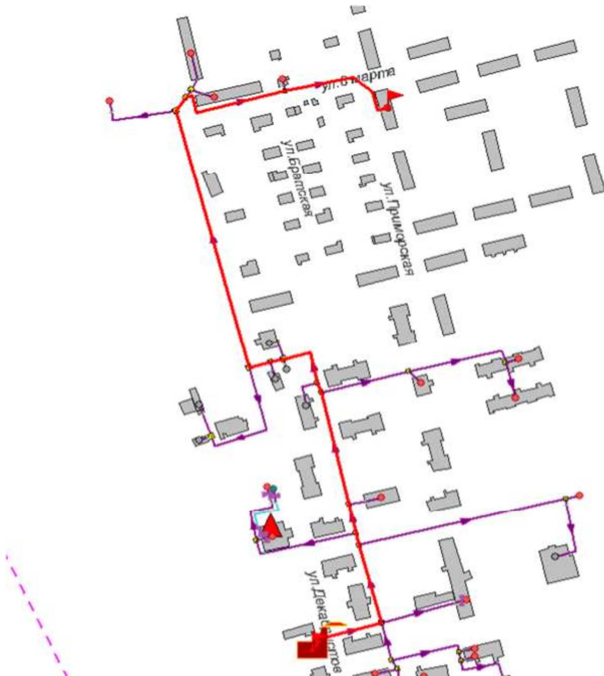
Рисунок 3.63 -Расчетный путь теплоносителя от котельной до Приморская,16
