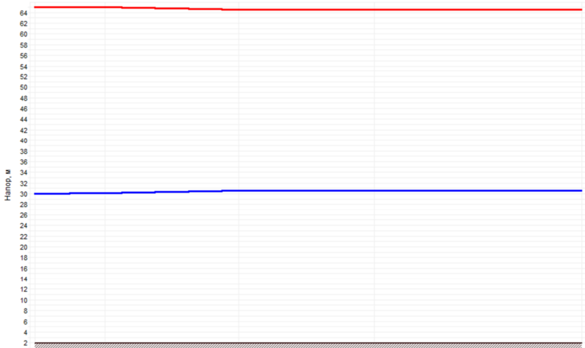
Рисунок 2.22 –График гидравлических режимов рассматриваемого теплопровода
