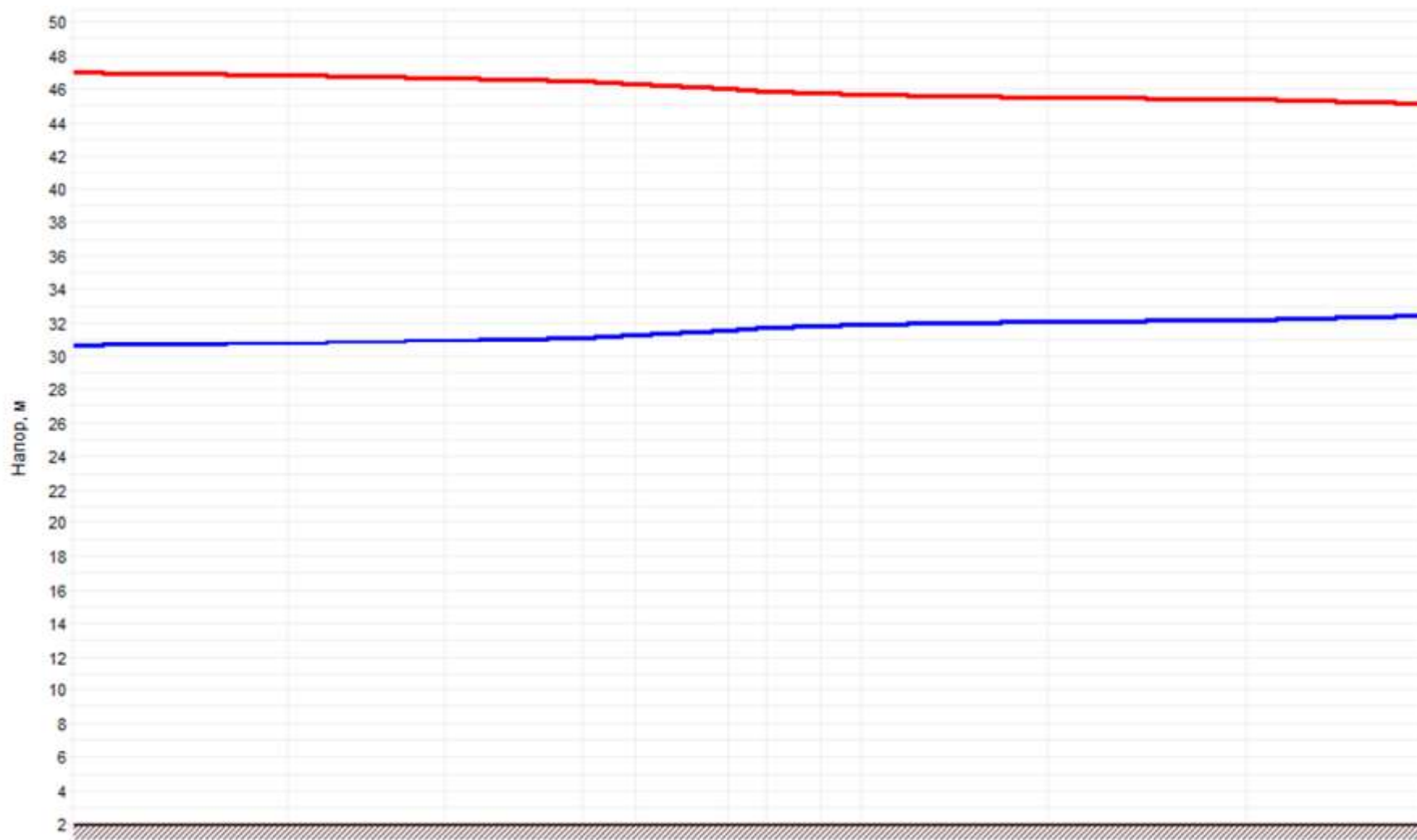
Рисунок 1.50 –График гидравлических режимов рассматриваемого теплопровода
