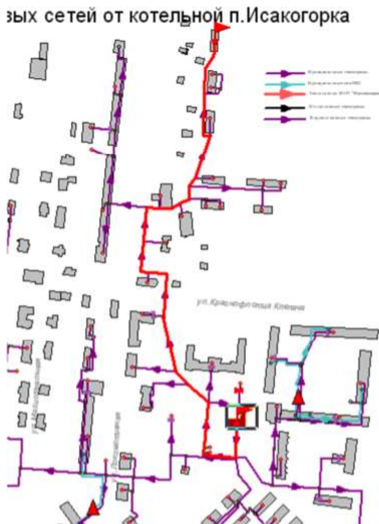
Рисунок 2.49 -Расчетный путь теплоносителя от котельной до Локомотивная,1
