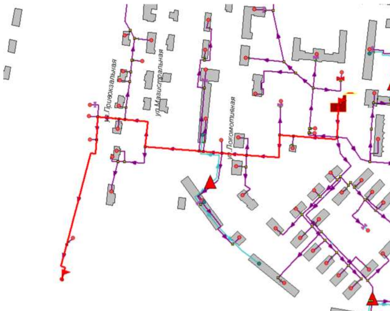
Рисунок 2.47 -Расчетный путь теплоносителя от котельной до Привокзальная, 19
