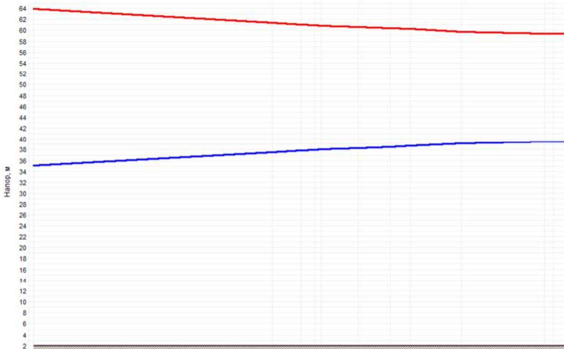
Рисунок 3.36 –График гидравлических режимов рассматриваемого теплопровода
