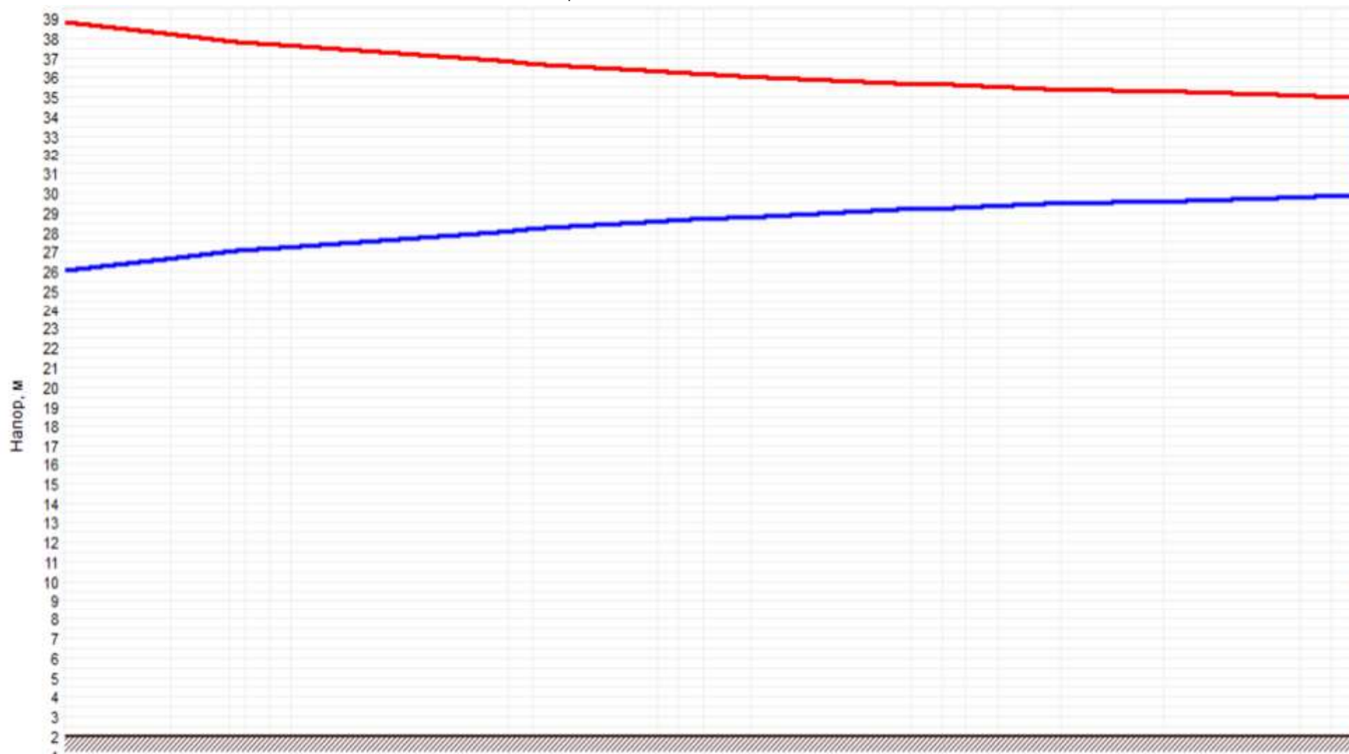
Рисунок 3.62 –График гидравлических режимов рассматриваемого теплопровода
