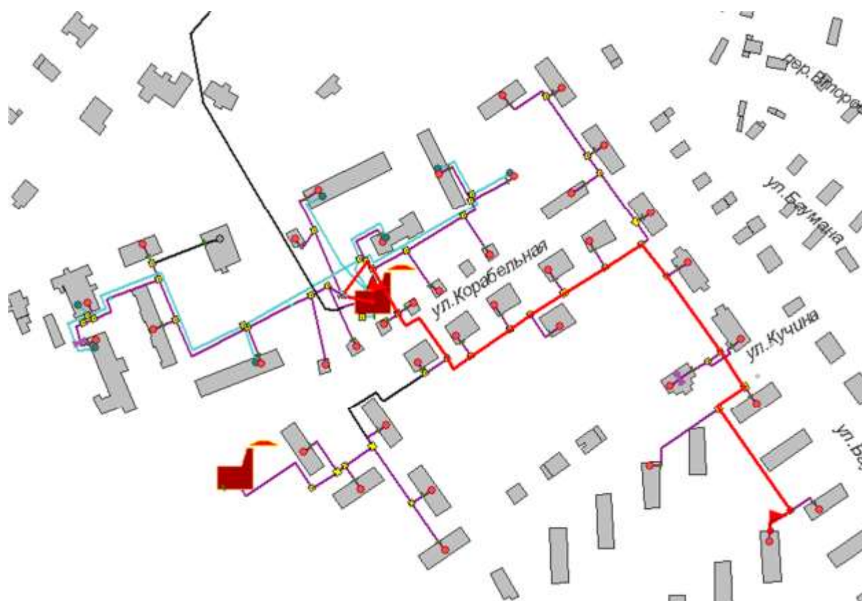
Рисунок 1.75 -Расчетный путь теплоносителя котельной до Баумана,12 к.4
