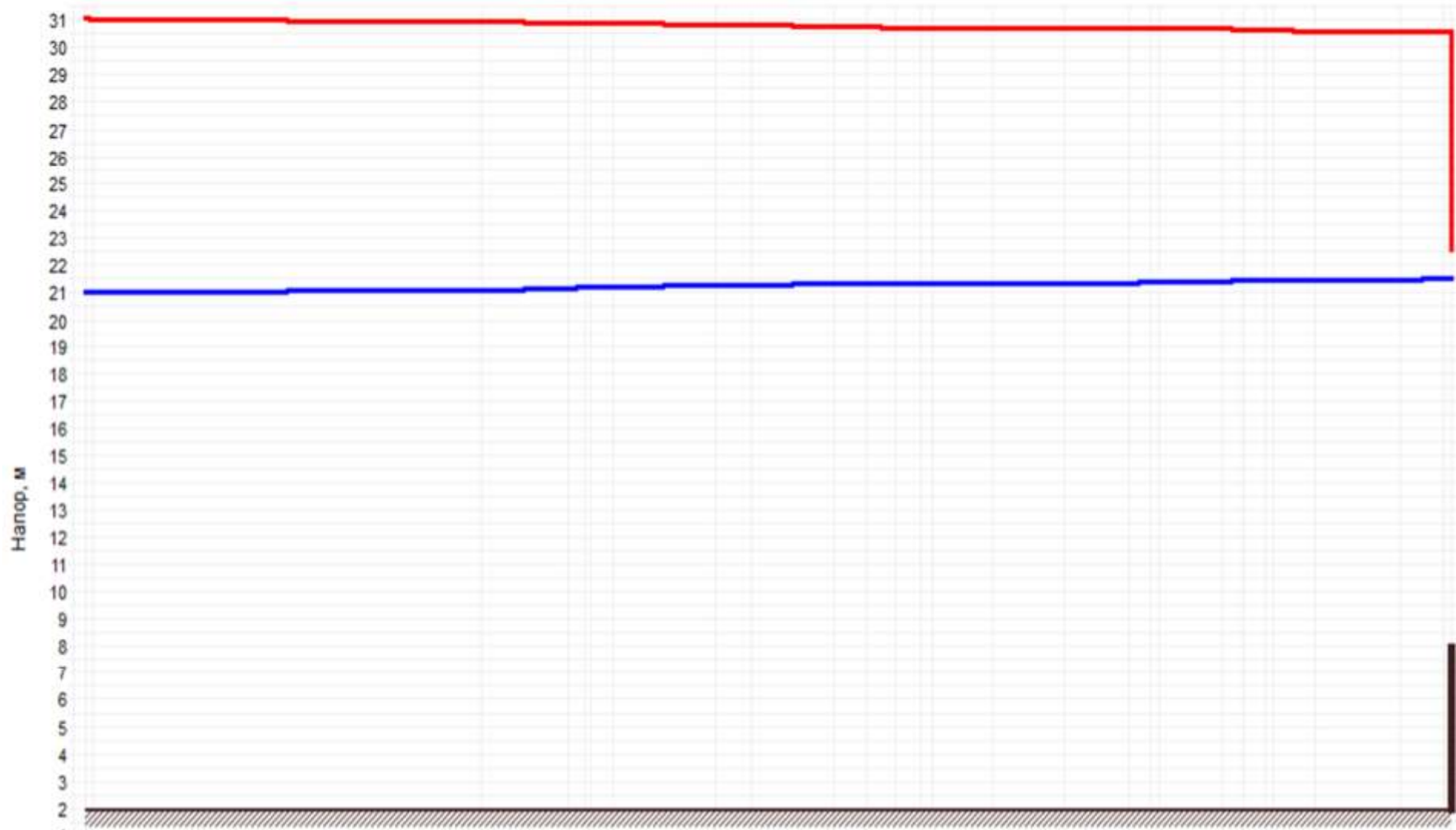
Рисунок 1.96 –График гидравлических режимов рассматриваемого теплопровода
