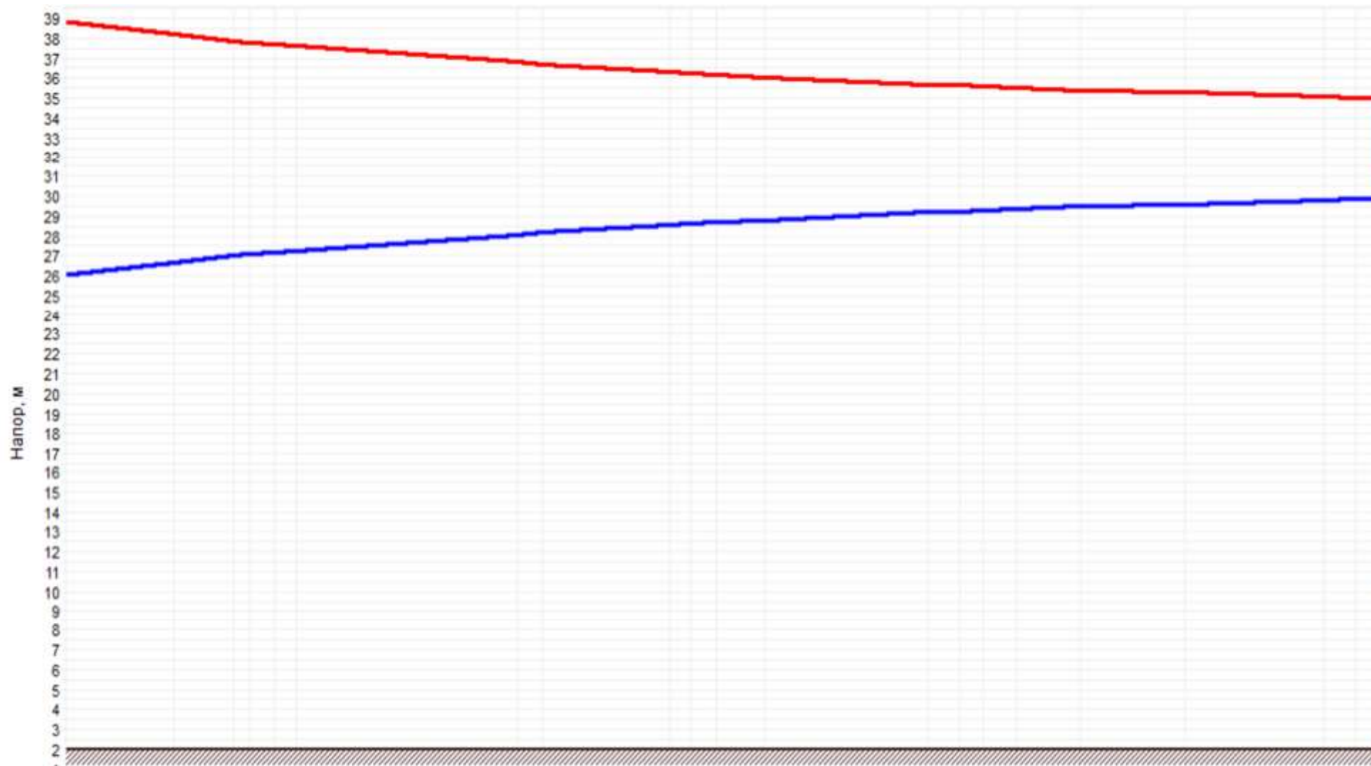
Рисунок 1.62 –График гидравлических режимов рассматриваемого теплопровода
