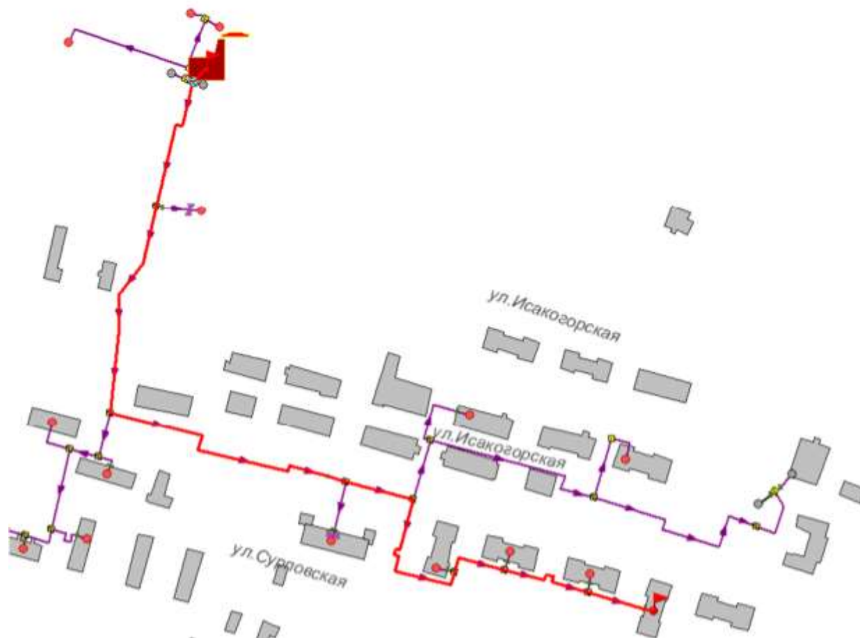
Рисунок 3.17 -Расчетный путь теплоносителя котельной до Сурповской, 20
