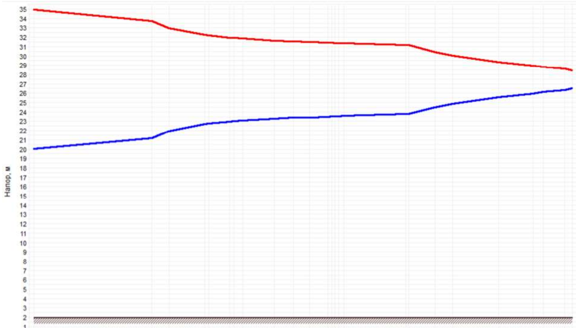
Рисунок 1.70 –График гидравлических режимов рассматриваемого теплопровода
