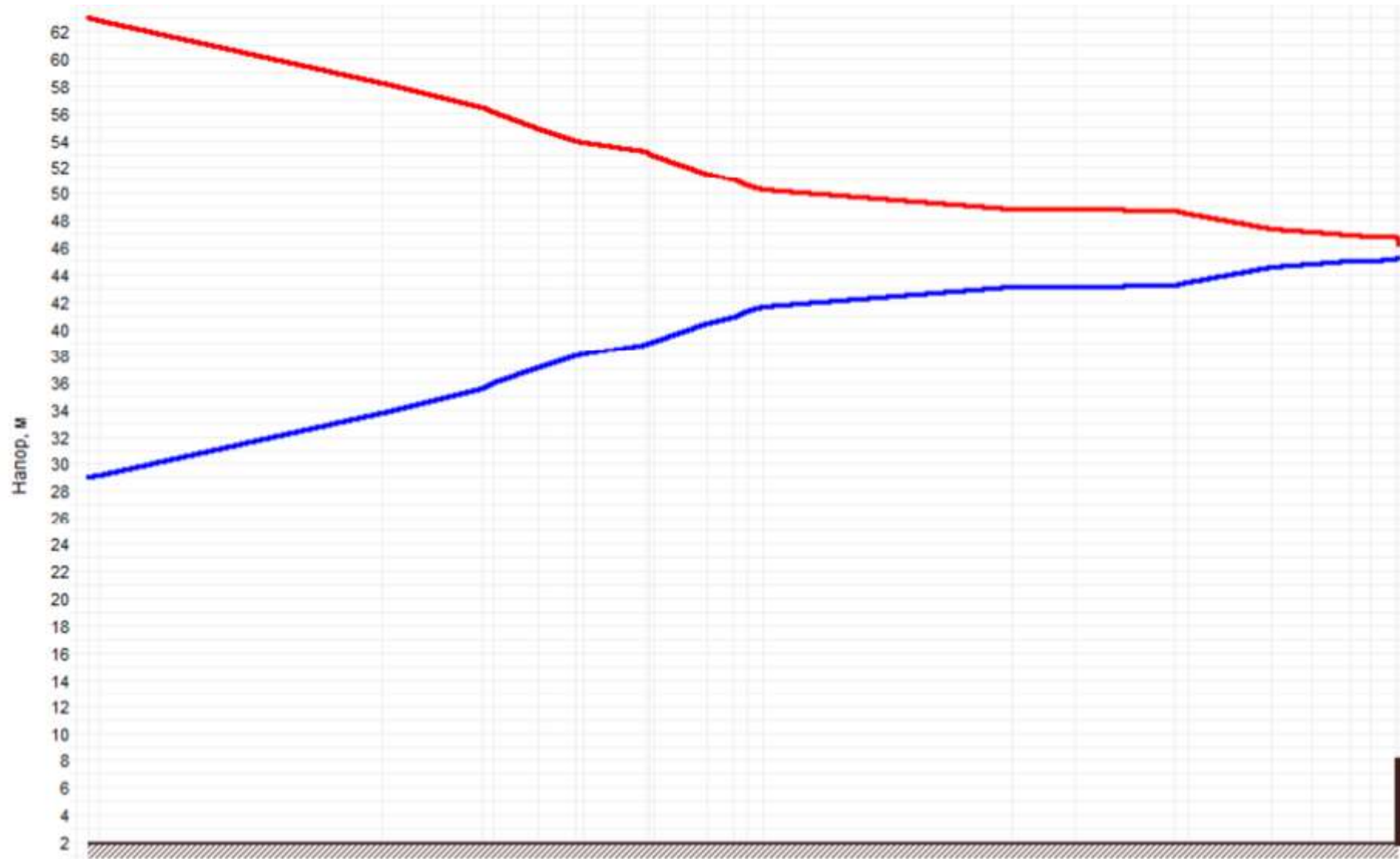
Рисунок 1.28 –График гидравлических режимов рассматриваемого теплопровода
