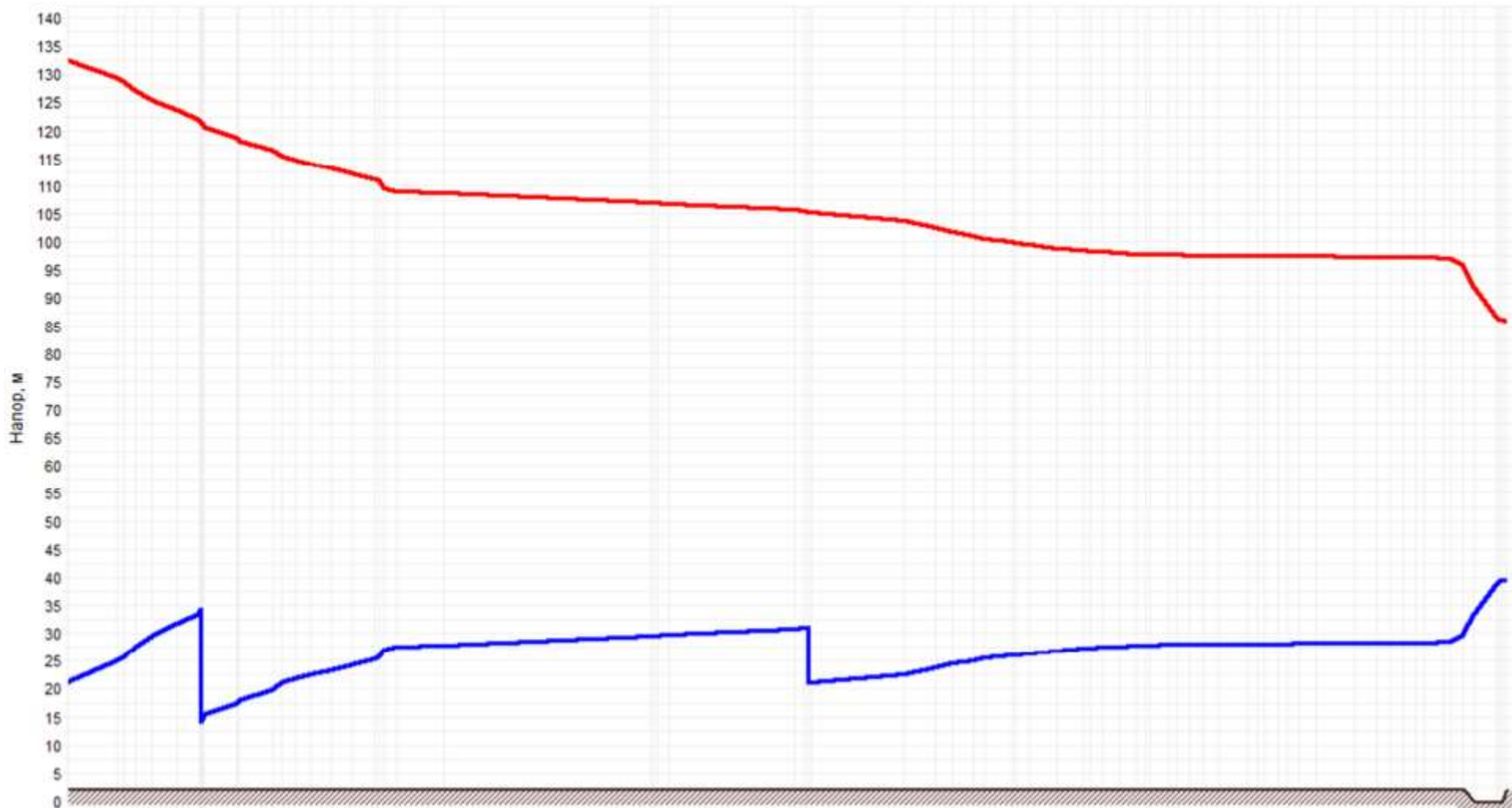
Рисунок 1.4 –График гидравлических режимов рассматриваемого теплопровода
